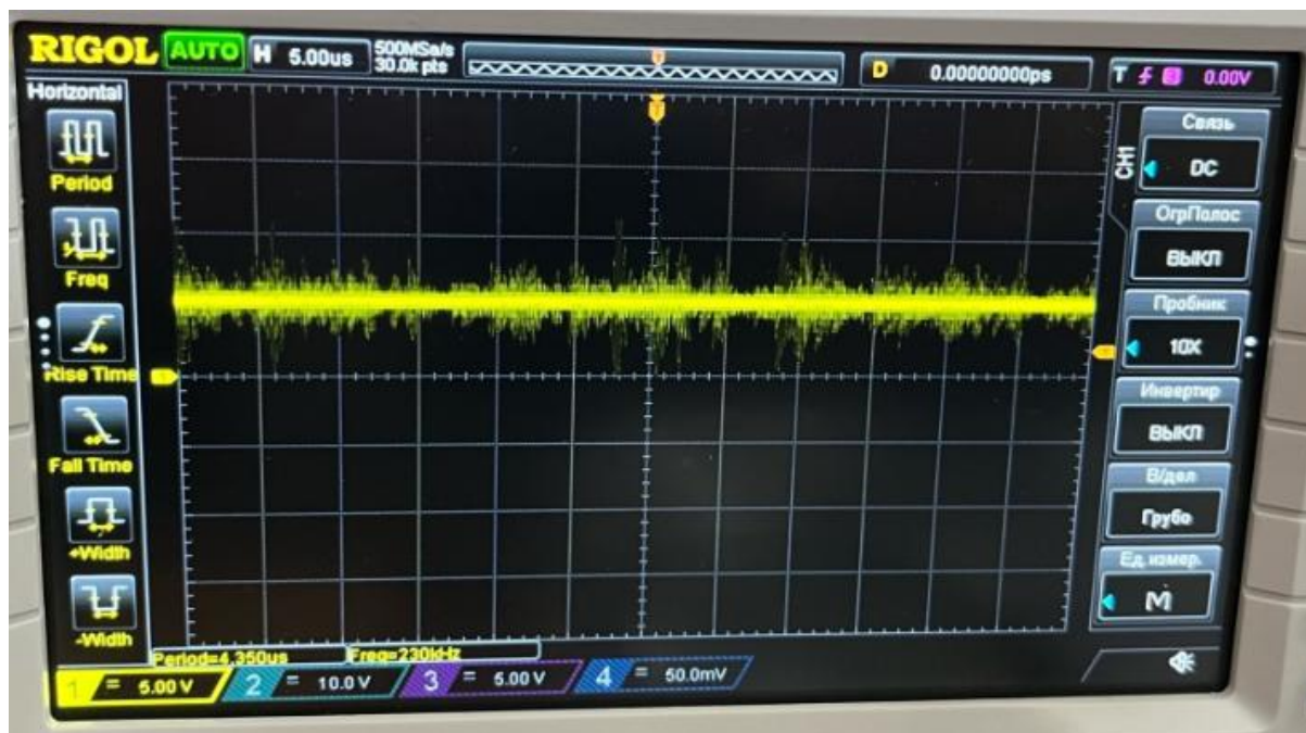
Рисунок 5 – Осциллограмма выходного напряжения на частоте вращения АДКР 920 об/мин
