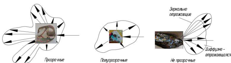
Рисунок 1 – Варианты индикатрисс рассеяния кусками руды
