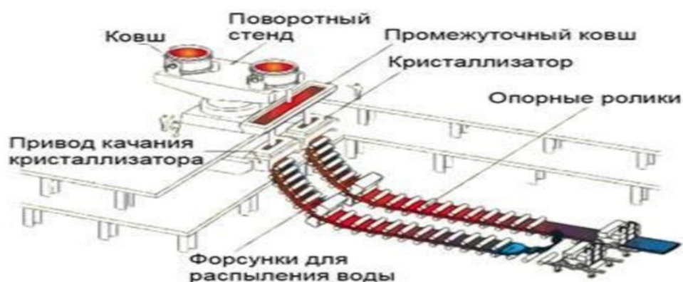
Рисунок 1 – Общая схема МНЛЗ
