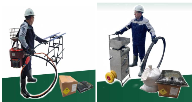
Рисунок 3 – Эмульсионные зарядчики типа РХ
