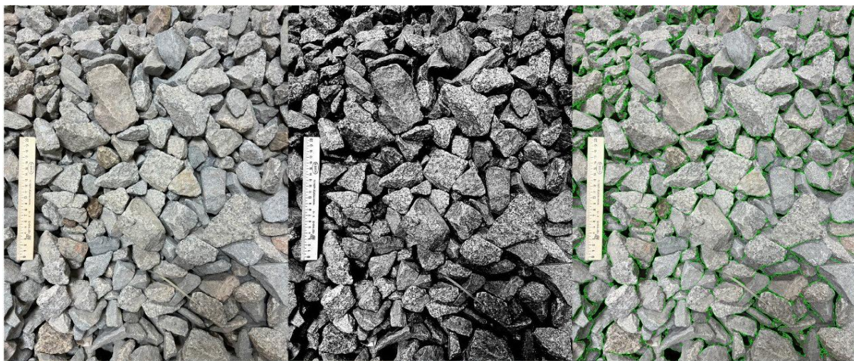
Рисунок 1 - Полный цикл обработки изображения с момента загрузки, предобработки и накладывание контуров программой.
