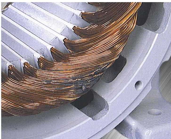
Рисунок 1 – Характерный вид межвиткового замыкания
