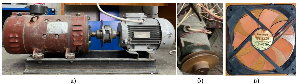
Рисунок 1 – Электромашинный агрегат лабораторного стенда, тахогенератор и кулер
