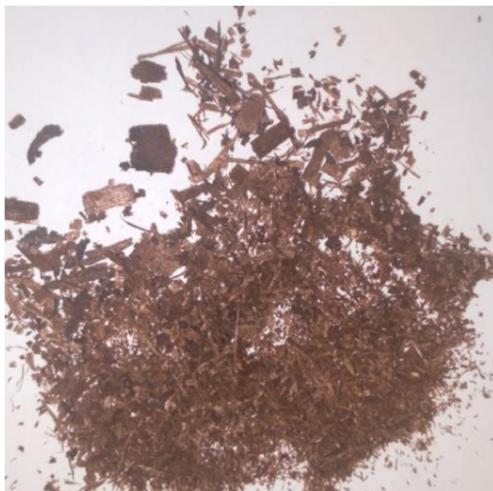
Рис. 1. Нефтесорбент из термомодифицированного опила сосны и осины
