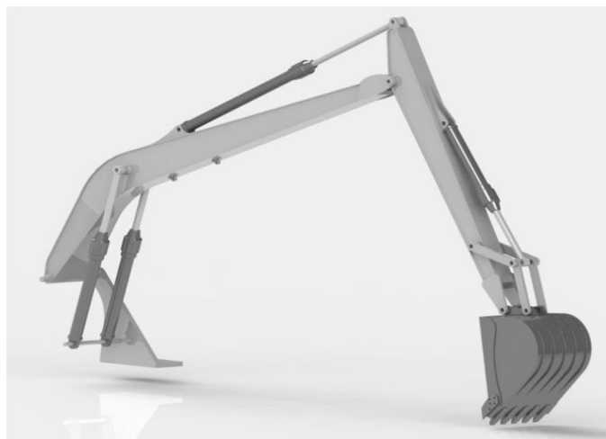
Рис. 4. Твердотельная модель рабочего оборудования экскаватора, созданная в среде Matlab Simulink
