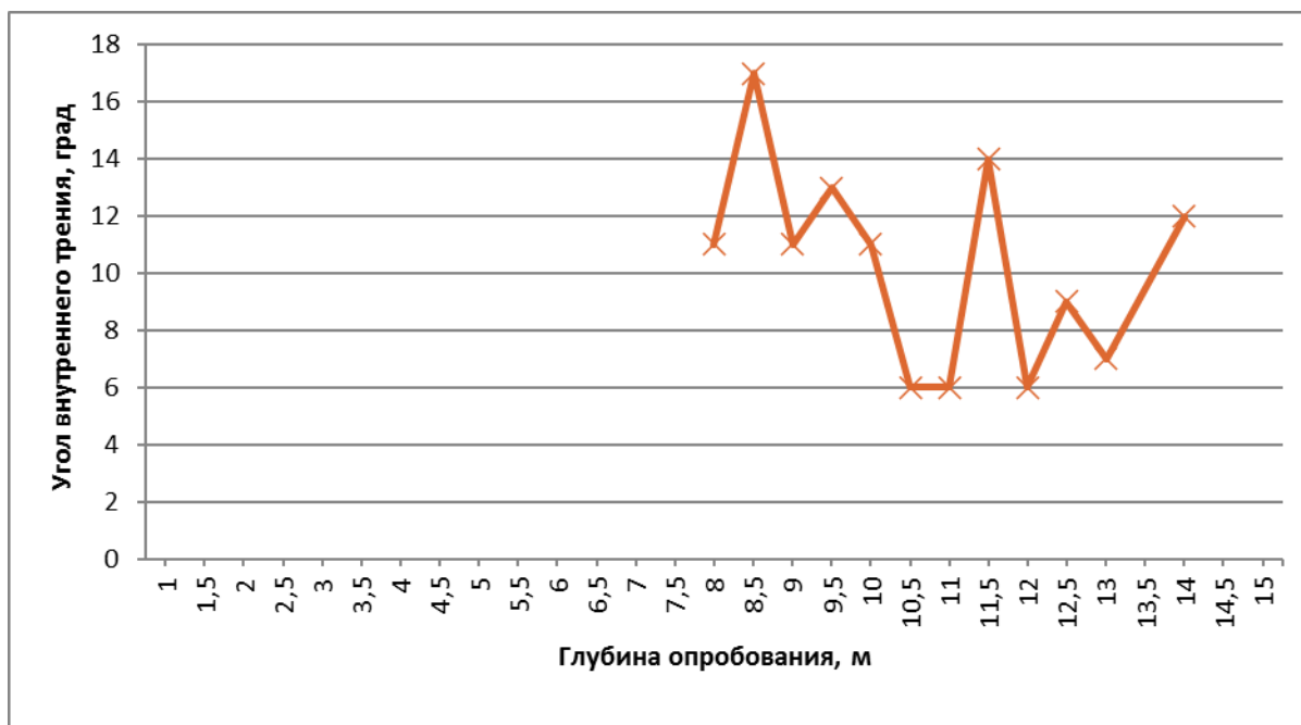
Рис. 2. График изменения по глубине шламохранилища № 3 усредненных показателей угла внутреннего трения шламовых грунтов
