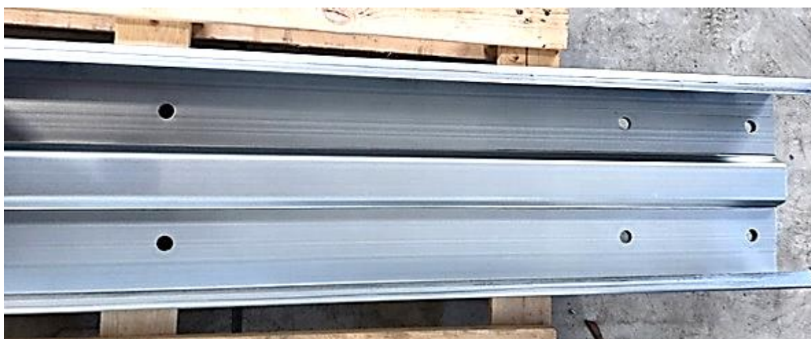
Рисунок 1 – фотография профиля ЛСТК.
