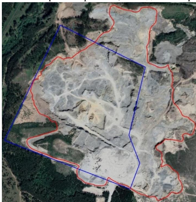
Рис. 1. Объект № 1. Граница горного отвода (обозначены синим цветом) и фактические границы проведения работ (обозначены красным)
