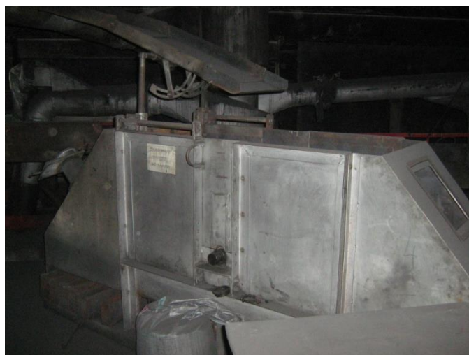
Рис. 1. Промышленная модель барабанно-полочного фрикционного сепаратора (БПФС)
