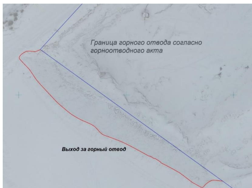
Рис 2. Объект № 2. Выход борта карьера за пределы горного отвода
