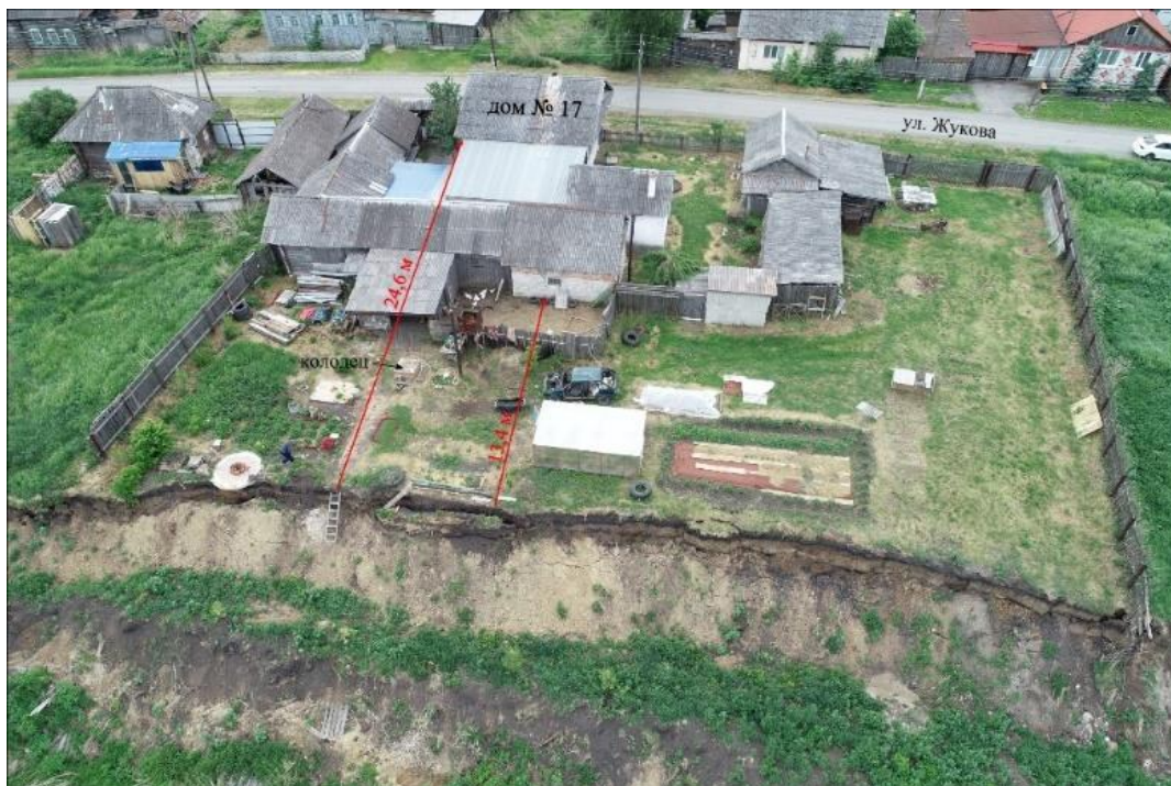
Рисунок 6 - Оползень на участке дома № 17 по ул. Жукова в д. Верхняя Иленка Свердловской области (фото с БВС)
