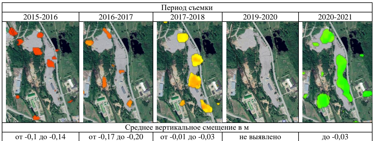
Рисунок 1 - Карты вертикальных смещений поверхности Земли на участке рекультивированного провала
