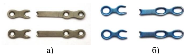
Рис. 3. Пластины из УМЗ титана (а) и фирмы ООО «Conmet» (б) после испытаний
