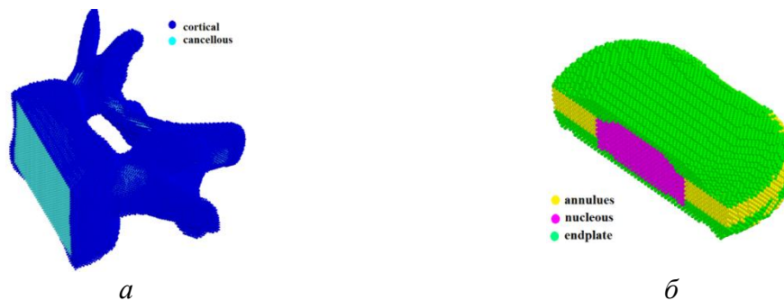
Рисунок 1. Элементы позвоночника, представленные в виде упаковки автоматов с условиями нагружения и срез: тело позвонка L4 (а), межпозвоночный диск L4-L5 (б)
