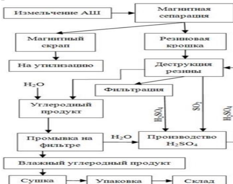
Рисунок 5 - Технологическая схема утилизации изделий из резины химическим методом.
