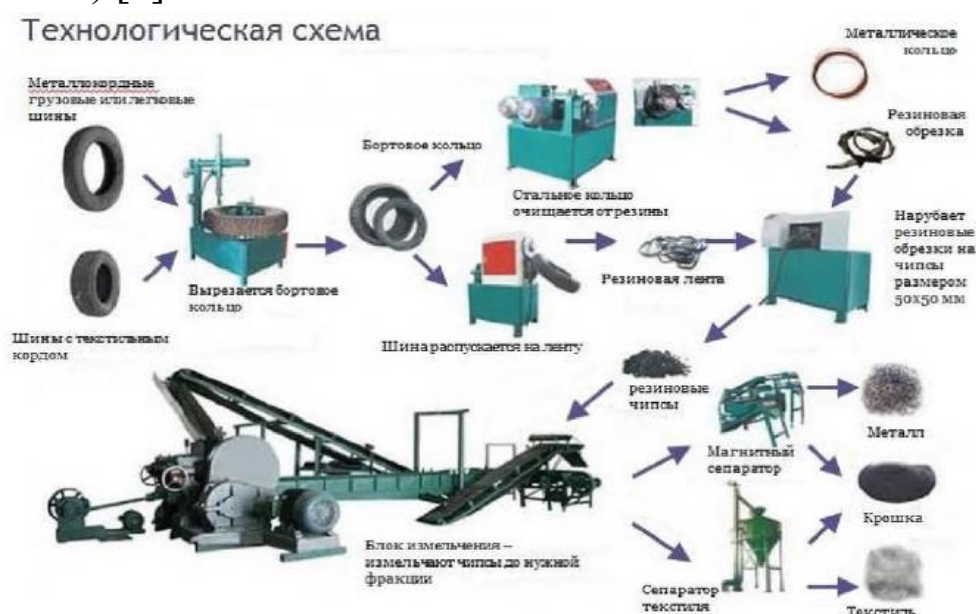
Рисунок 3 - Технологическая схема утилизации изделий из резины физическим методом.
