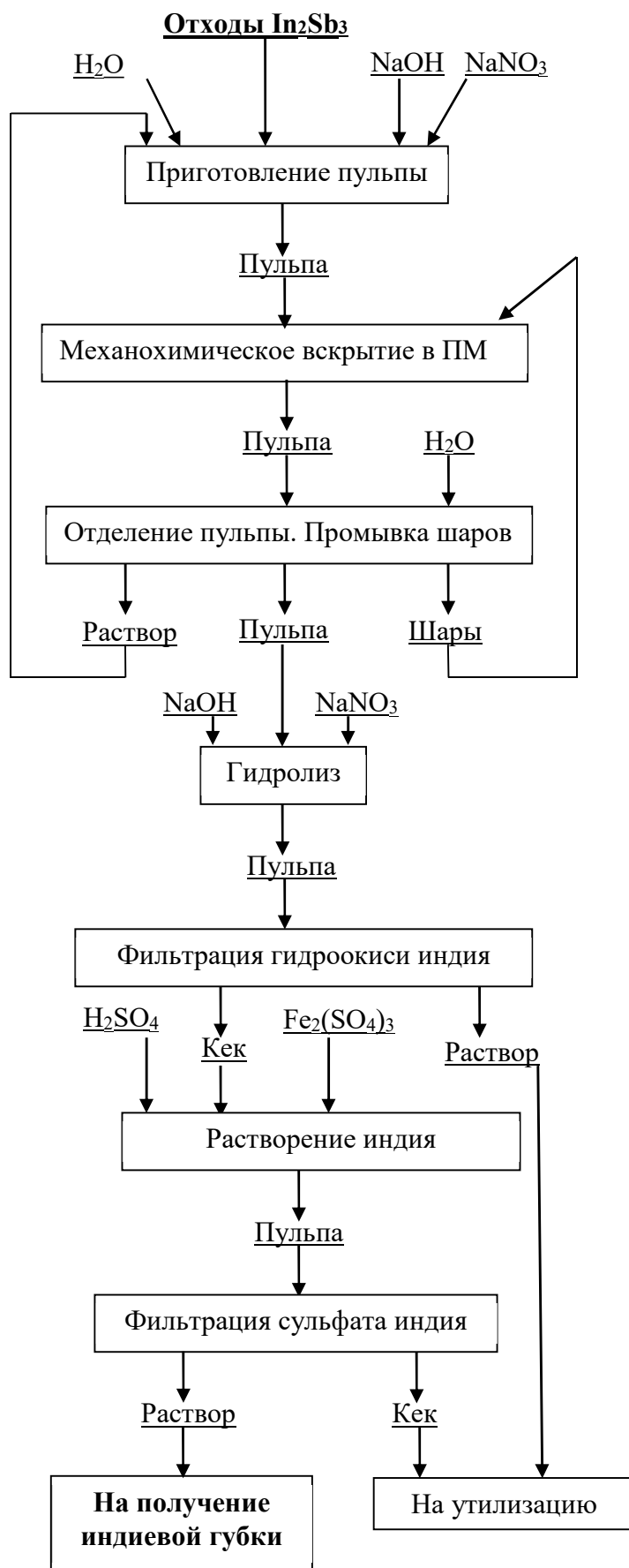
Рисунок 1 – Схема переработки отходов антимионида индия
