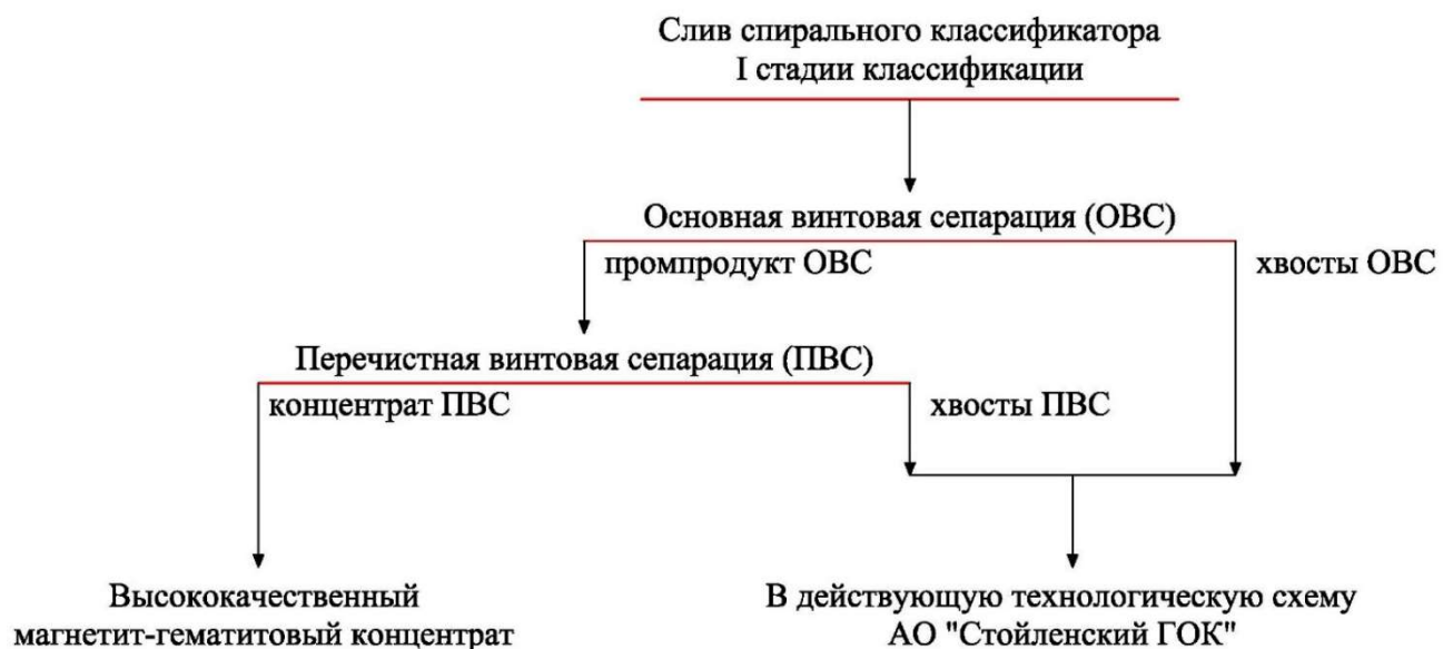
Рисунок 2 – Технологическая схема промышленных испытаний винтовой сепарации на одной из полусекций АО «Стойленский ГОК»
