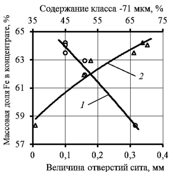
Рисунок 2 – Зависимость массовой доли Fe в концентрате от величины отверстия сита (1) и от массовой доли класса –0,071 мм в концентрате (2)
