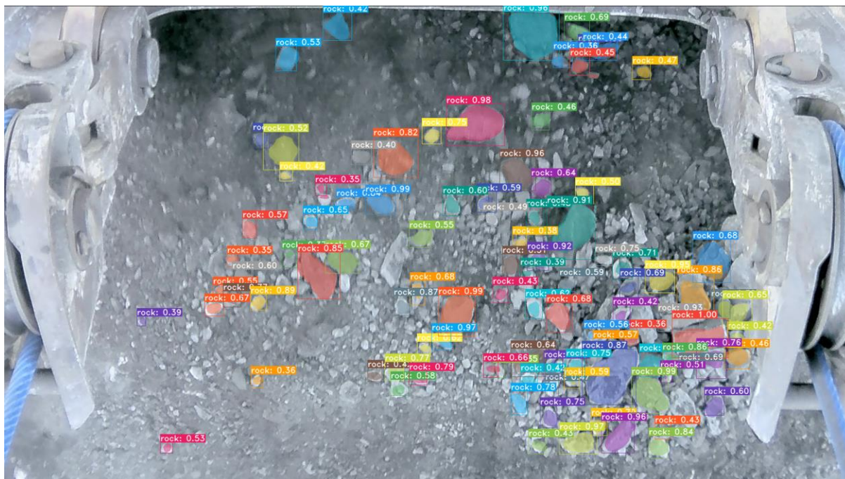
Рисунок 1 – процесс определения гранулометрический состава породы
