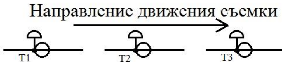
Рисунок 1 – Схема спутниковой съемки линий связи вплотную: Т1, Т2, Т3 – точки съемки
