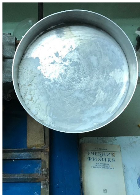
Рисунок 2 – Получение чешуйчатого нитрата кальция на грануляторе
