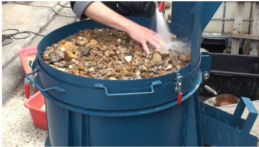
Рисунок 3 – Промывка пробы на концентраторе
