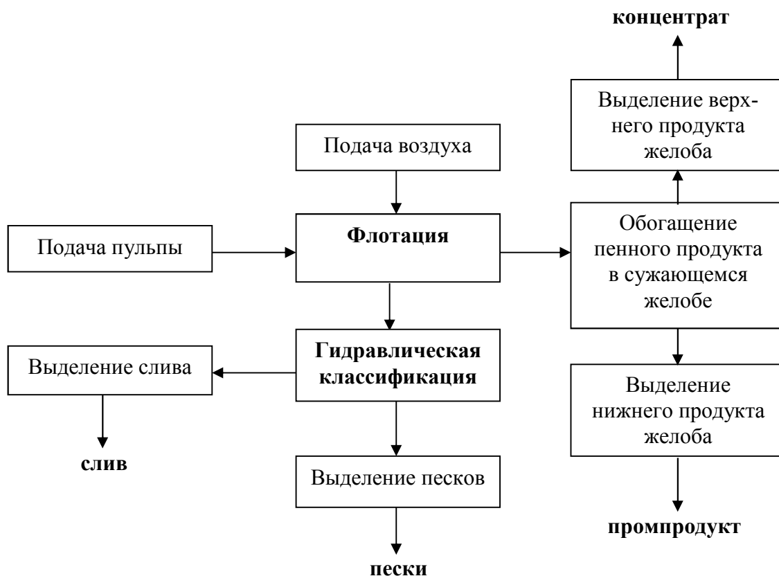
Рисунок 3 – Структурная схема флотоклассификации с разделением пенного продукта в сужающихся желобах
