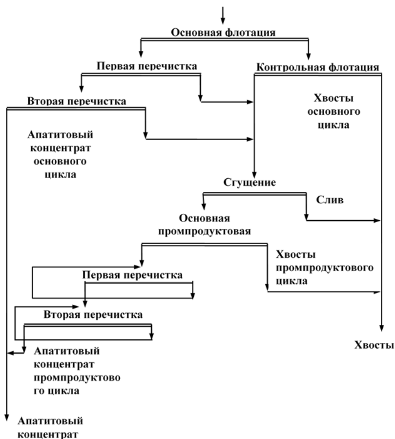
Рисунок 2 – Схема обогащения тонких хвостов с промпродуктовой флотацией
