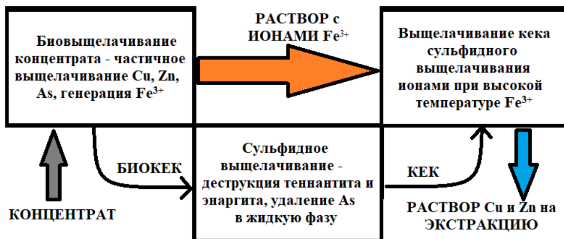
Рисунок 1 – Блок-схема предлагаемой технологии трехстадийного выщелачивания
