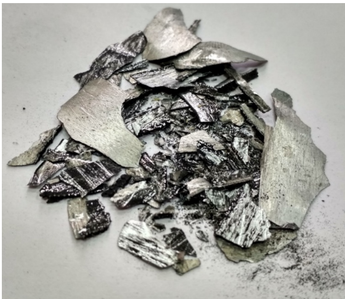
Рисунок 4 – Фотография катодного цинка, полученного в результате опытов, проведенных в замкнутом цикле
