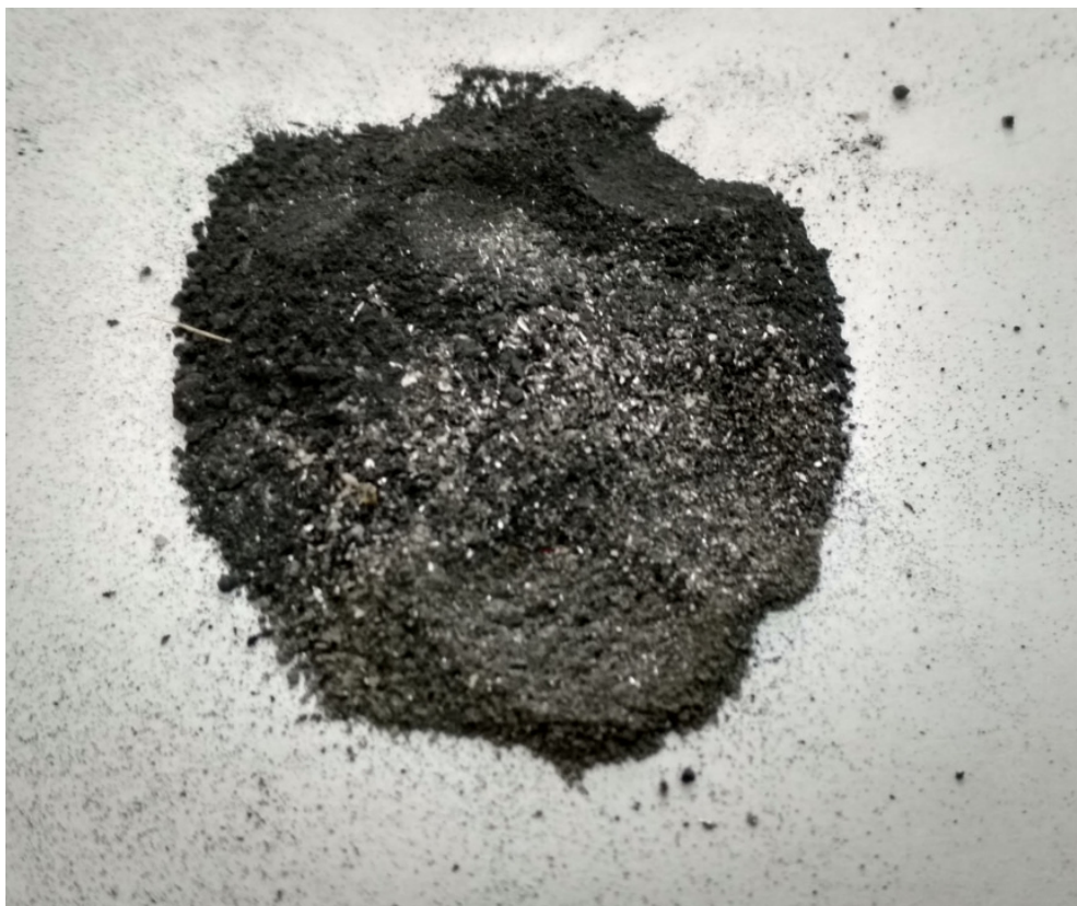
Рисунок 2 – Фотография металлического цинка, счищенного с катода
