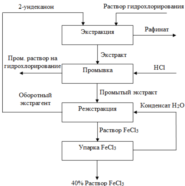
Рис. 2 Принципиальная технологическая схема экстракционного получения концентрированного раствора хлорного железа из хлоридного раствора
