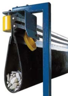
Рис.4. Конвейер с подвесной лентой
