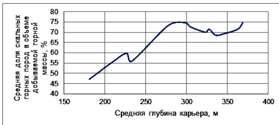
Рис. 2. Увеличение средней глубины карьера и повышение доли скальных горных пород в общем объеме добываемой горной массы
