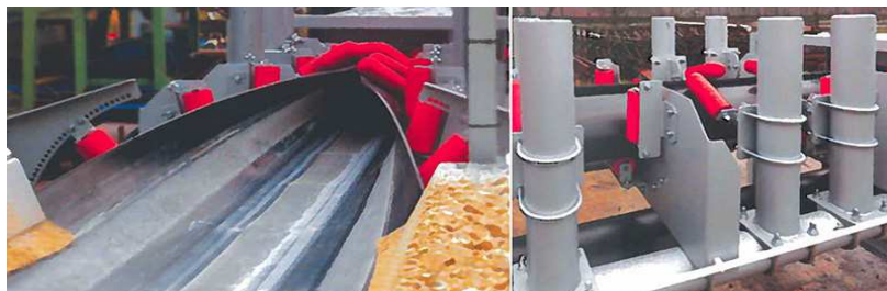
Рис. 3. Трубчатый крутонаклонный конвейер
