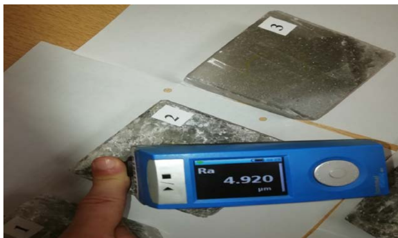
Рис. 2. Использование профилометра Hommel-Etamic W5
