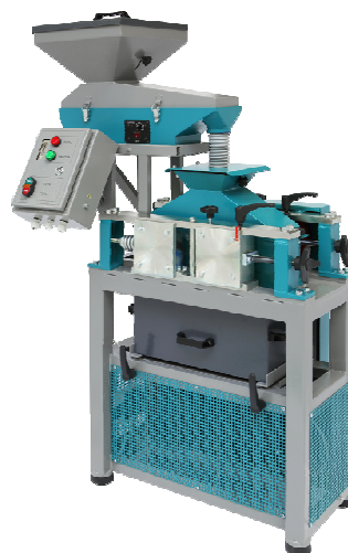
Рис. 2. Установка на основе валковой дробилки ДВГ 200x125 с пультом МАПУЗ и питателем ПГ 1 на опоре
