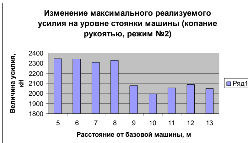
Рис. 2 Характер изменения максимально реализуемого усилия на уровне стоянки экскаватора ЭГ-12А (копание рукоятью; режим № 2)
