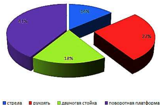
Рисунок 4– Структура отказов металлоконструкций карьерных экскаваторов в условиях рудных карьеров Южного Урала
