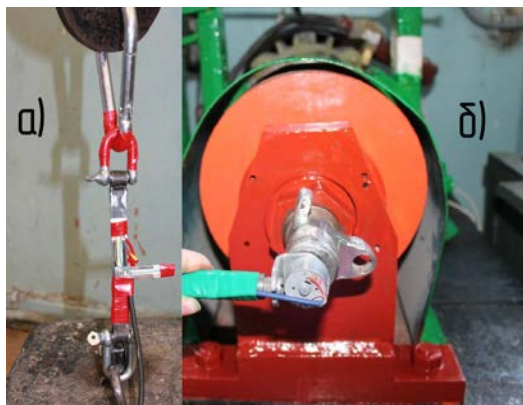
Рис. 4. Пример подключения первичных преобразователей для определения характеристик: а) размещение тензометрических датчиков, б) подключение тахогенератора
