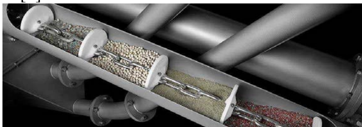
Рис. 5. Селективной транспортировки горных пород в скребковом конвейере
