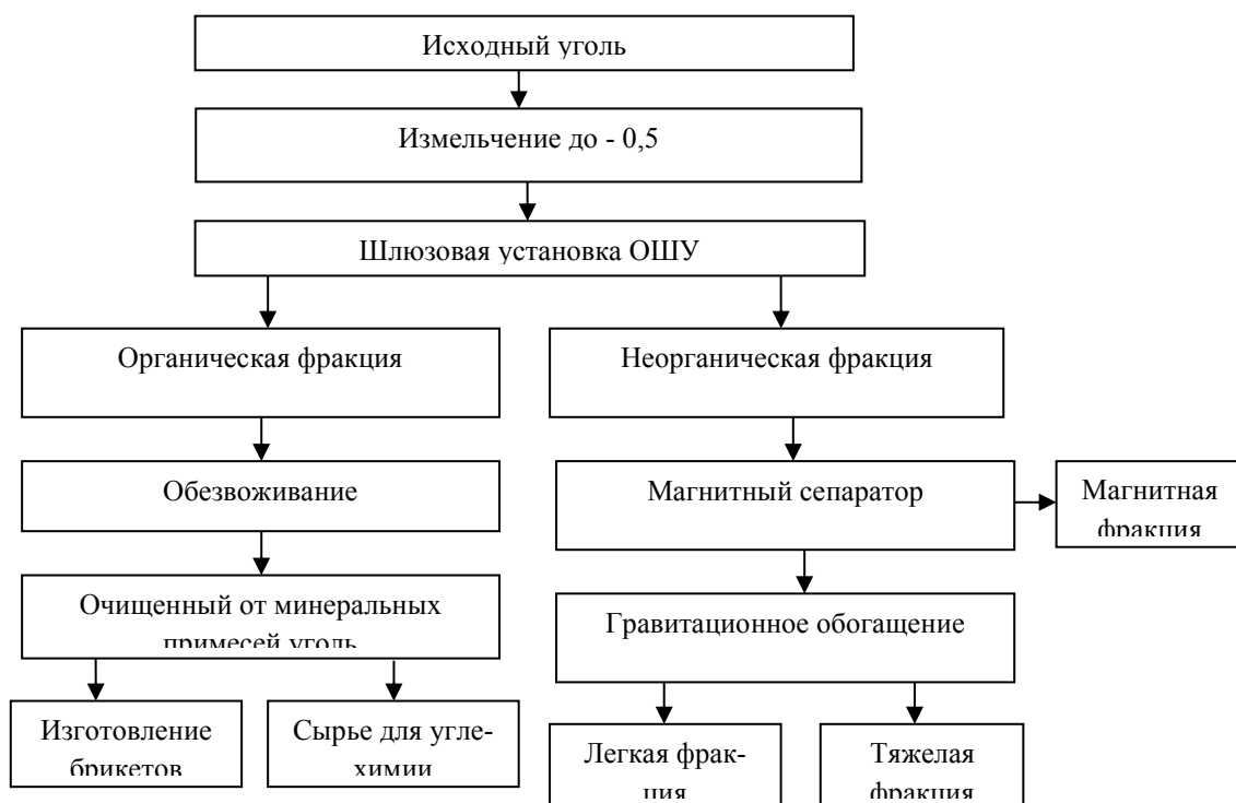
Рисунок 1 - Технологическая схема получения из исходного бурого угля сырья для получения продукции многоцелевого назначения
