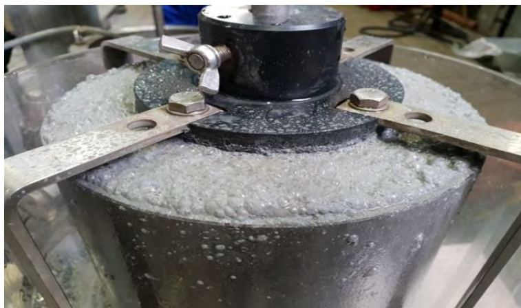
Рисунок 2 — Контрольная дофлотация хвостов шеелитового цикла на Pneufлот
