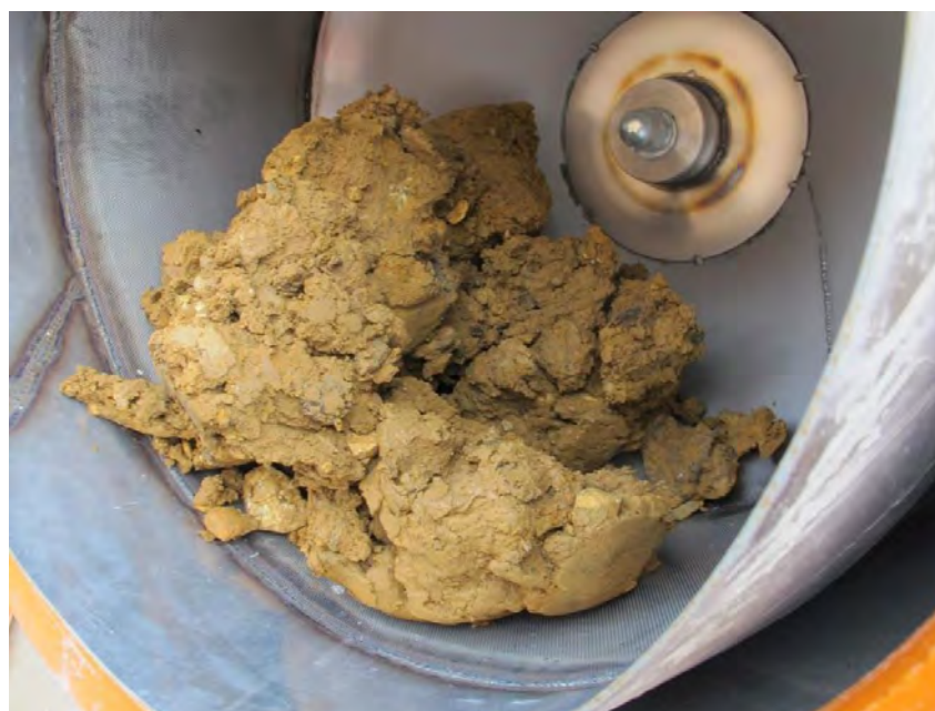
Рисунок 3 – Исходная глинистая проба в барабане дезинтегратора
