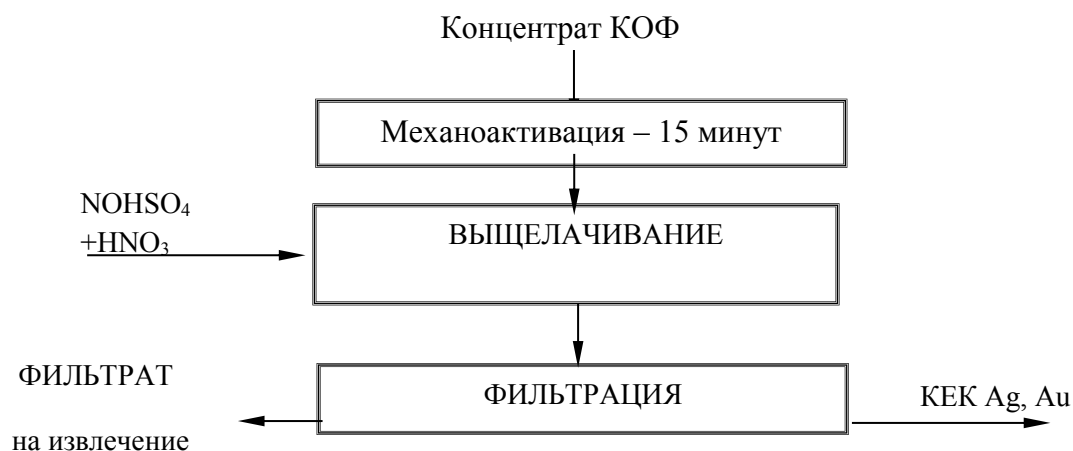
Рисунок 1 – Принципиальная технологическая схема выщелачивания концентрата КОФ
