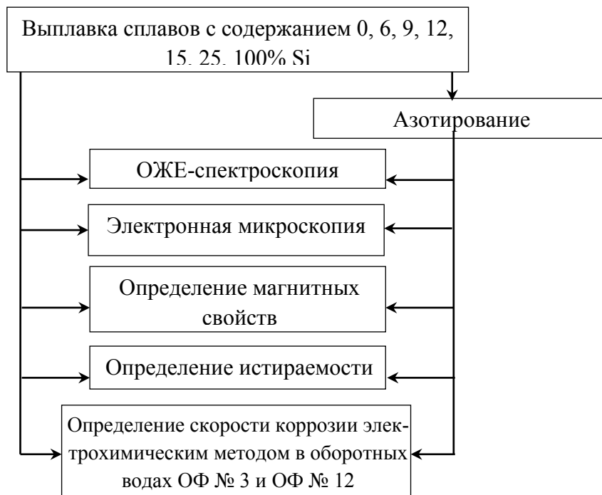
Рисунок 1 – Схема исследований сплавов ферросилиция с различным содержанием основных компонентов
