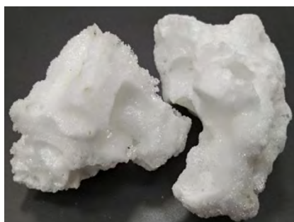
Рисунок 3 – Силикатная часть расплава (пеносиликат)
