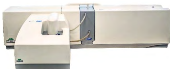
Рисунок 6 – Лазерный дифракционный анализатор размера частиц Mastersizer 2000
