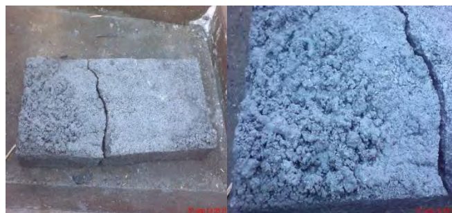
Рисунок 4 – Пробы с влажностью 30 и 40 % в замершем состоянии
