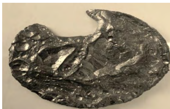
Рисунок 1 - Слиток чугуна полученный из гидрогранатового шлама
