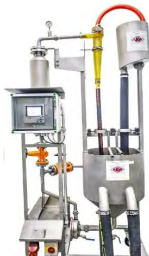
Рисунок 1 – Лабораторная установка гидроклассификации AKW Laborant ZLF 50-CH компании AKW Apparate und Verfahren GMBH (Германия)
