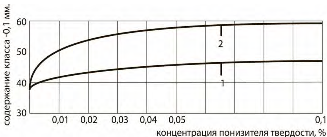
Рисунок 2 - Зависимость массовой доли класса минус 0,1 мм в измельченной руде от концентрации NaCl
