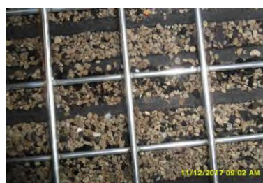
Рисунок 3 - Выделение на ОШУ неорганических примесей
