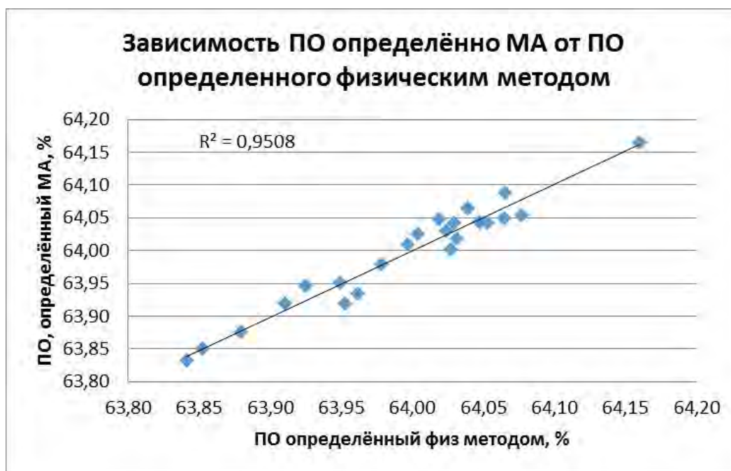
Рисунок 1 – Зависимость ПО, определённого ПСМ, от ПО определённого магнитным анализом
