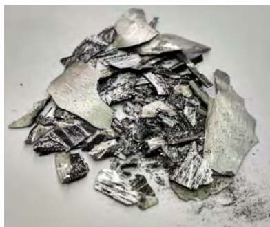
Рисунок 2 – Катодный цинк из возгонов плавления шламов
