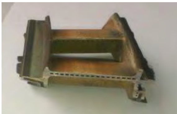
Рисунок 1 - Рабочая лопатка ротора турбины двигателя из литейного никелевого жаропрочного сплава, бывшая в эксплуатации
