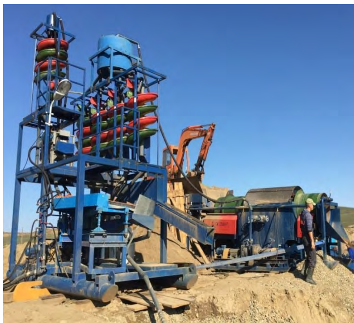
Рисунок 1 – Обогатительный комплекс винтовой сепарации, производительностью 10 м 3 в час (ОКВ-10), производства ООО ПК «Спирит»
