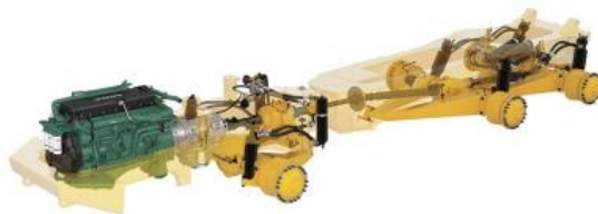
Рис. 2. «Рентген» трансмиссии и фирменной подвески VolvoFullSuspension
