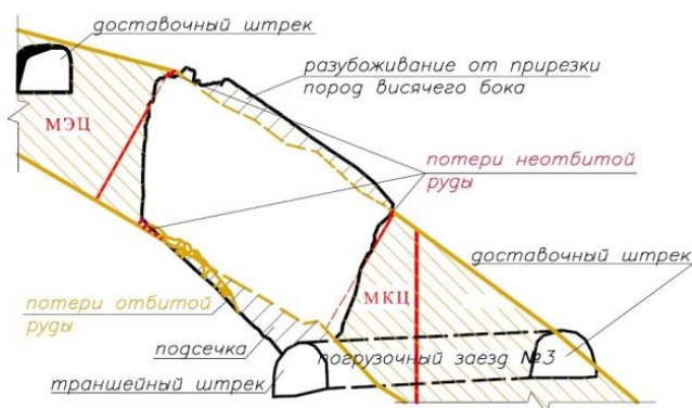
Разрез по Камере 1, полученный по результатам объемного лазерного сканирования
