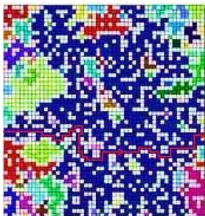
Рис. 1. Простейшая перколяционная модель [4]: цветами обозначены перколяционные кластеры, в частности синим – кластер, по которому происходит протекание; красная стрелка – один из путей просачивания
