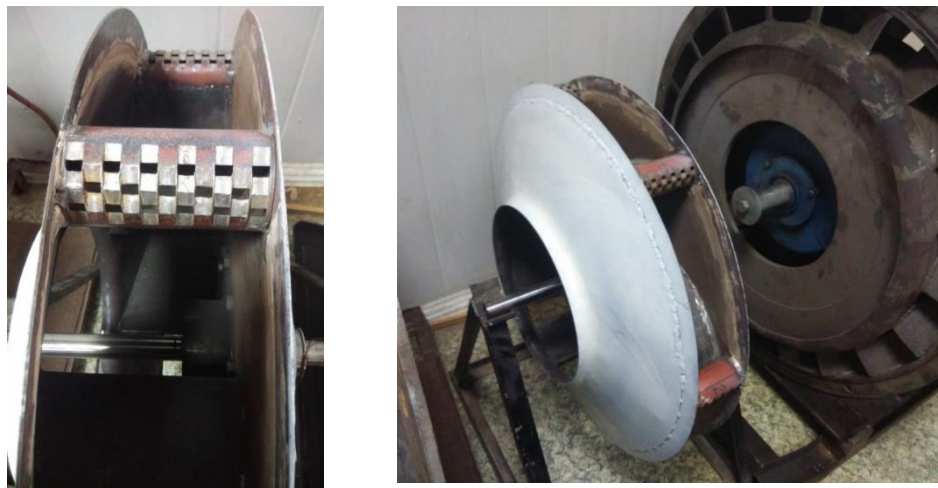
Рис. 2. Вентилятор типа ВРВП с адаптивными вихреисточниками на рабочем колесе
