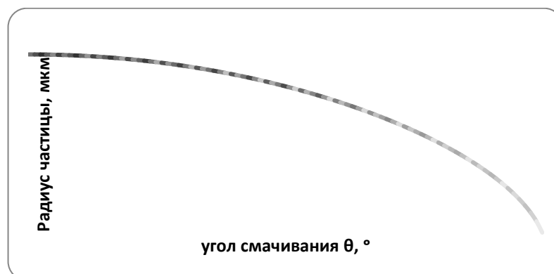
Рис. 1. График зависимости радиуса твердой частицы (R) золота от угла смачивания этой частицы оксидным расплавом (θ)
