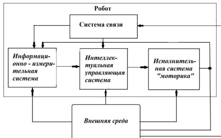
Рис. 1. Структурно-функциональная схема взаимодействия систем робота с окружающей средой
