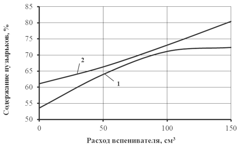
Рисунок 3 – Сравнение зависимостей содержания пузырьков диаметром меньше 1 мм от расхода вспенивателя, при давлении 0,33 кг/см 2 : 1 – диспергатор со свободной рабочей поверхностью; 2 – диспергатор с рабочей поверхностью, покрытой сетчатым материалом
