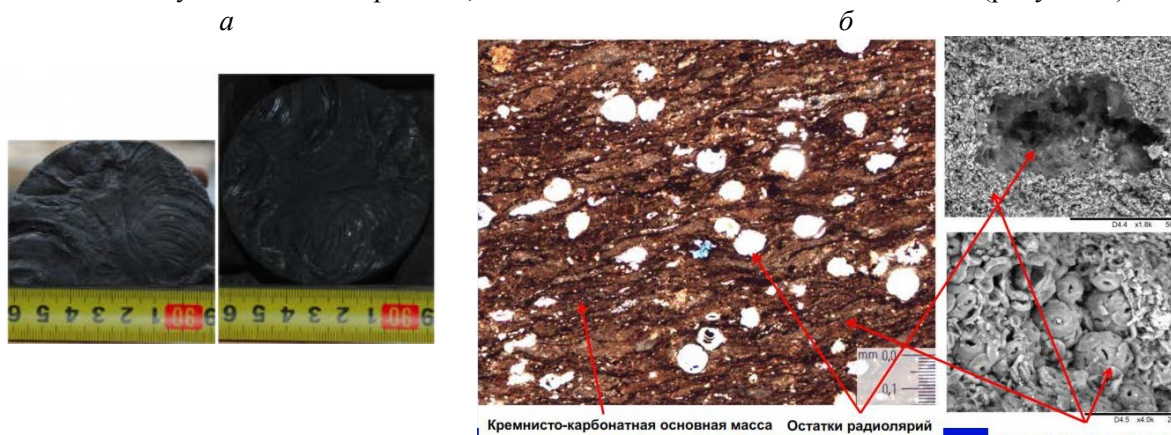
Рисунок 1 – Скопление раковин двустворчатых моллюсков Buchia в породах баженовской свиты (а) и остатки радиолярий и кокколитофорид в шлифе (б)
