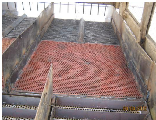
Рисунок 2 – Фрагмент сеющей поверхности грохота промприбора ПЗШ-П-150 (2012 г.)
