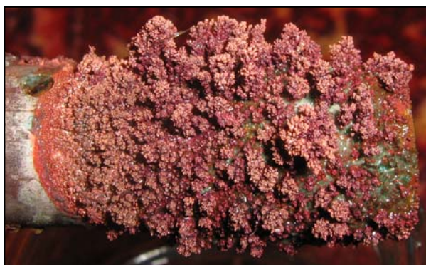
Рис. 5. Слева – медь самородная, выращенная с помощью электролиза при высоких плотностях тока, справа – монокристалл кристалл арканита ( K_2SO_4 ), выращенный при низких температурах (в холодильнике) в течение месяца
