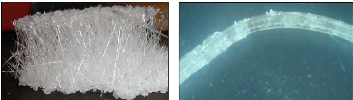
Рис. 3. Слева – обычные кристаллы аммиачной селитры, справа – кристаллы, выращенные в добавочном магнитном поле (постоянный магнит)
