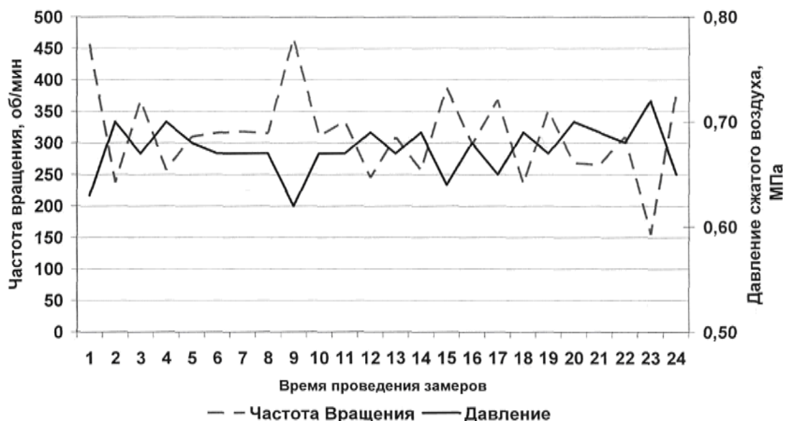
Рис. Зависимость частоты вращения двигателя от давления воздуха в пневмосети
