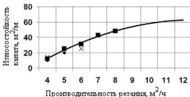
Рис. Среднестатистическая зависимость между производительностью (скоростью резания) и стойкостью алмазного каната на уральских карьерах мрамора и серпентинита
