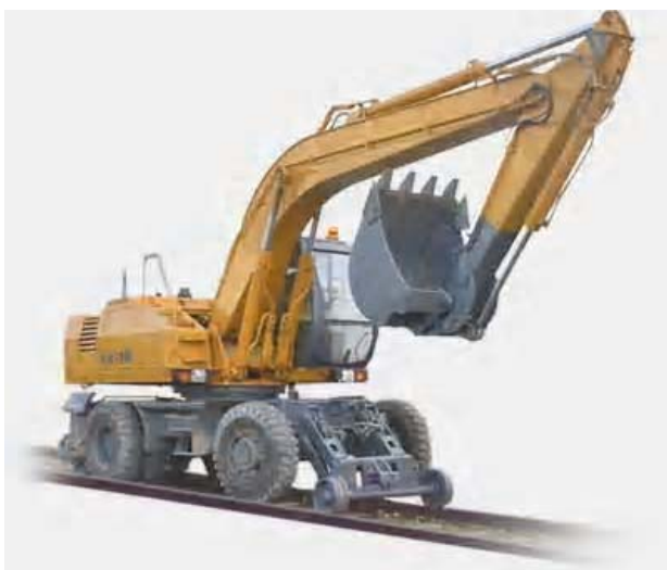
Рис. Дорожно-рельсовые транспортные средства на базе автомобилей “Урал” (вверху); колесные экскаваторы типа ЕК-18 с приспособлениями для рельсового хода
