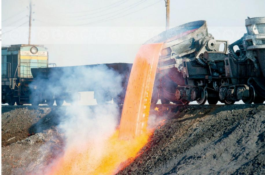
Шлаковый отвал СУМЗ формируется с 1940 года и является действующим, содержание полезных компонентов в нем составляет:  $\text{Cu} - 0,7-0,9 \%$ ;  $\text{Zn} - 3-4 \%$ ;  $\text{Au} - 0,2-0,4 \text{ г/т}$ ;  $\text{Ag} - 3,4-5,0 \text{ г/т}$ . Объем переработки на сегодняшний день насчитывает более 1 млн тонн шлака в год, в результате чего объем ранее накопленных на отвале шлаков ежегодно сокращается на 650 тыс. тонн.
