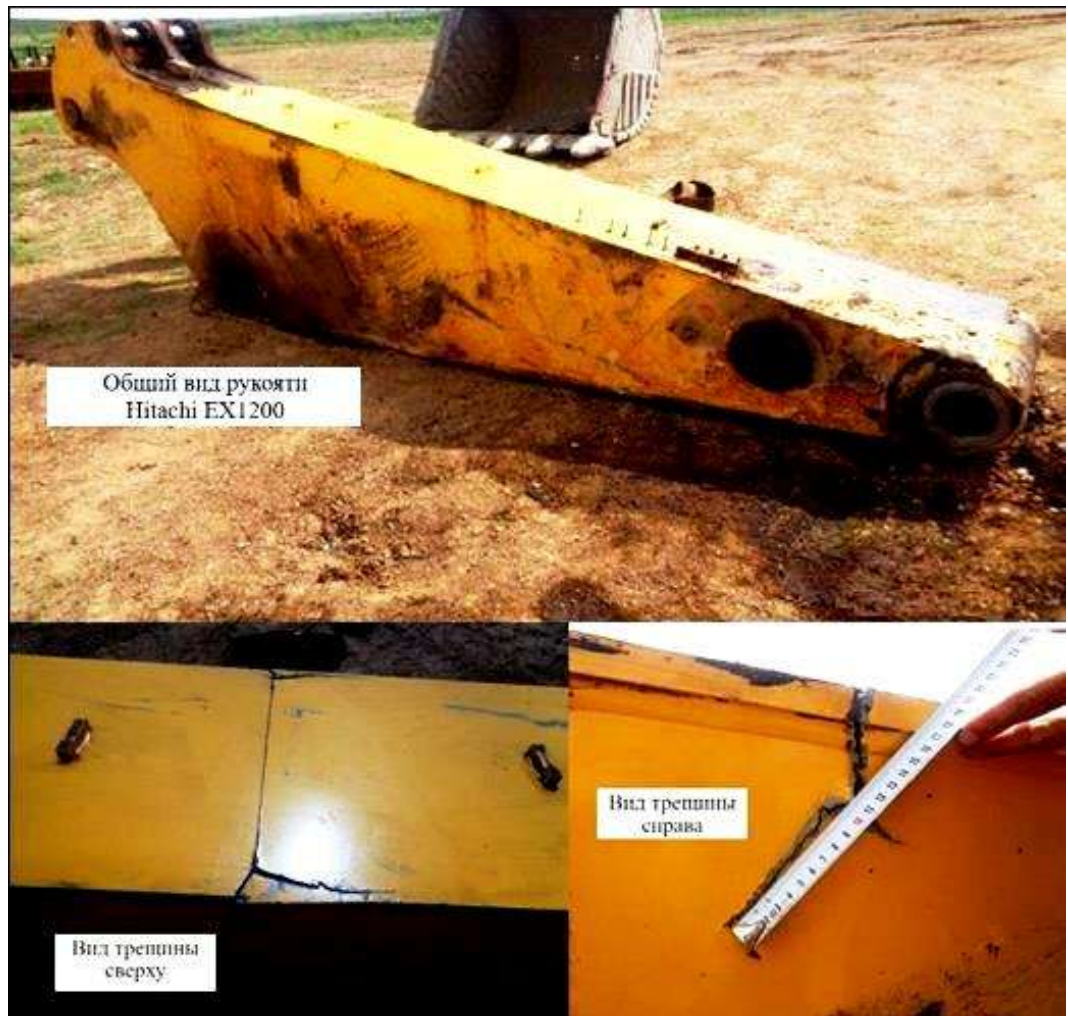
Рисунок 1.8 – Трещина в рукояти гидравлического экскаватора Hitachi EX1200
