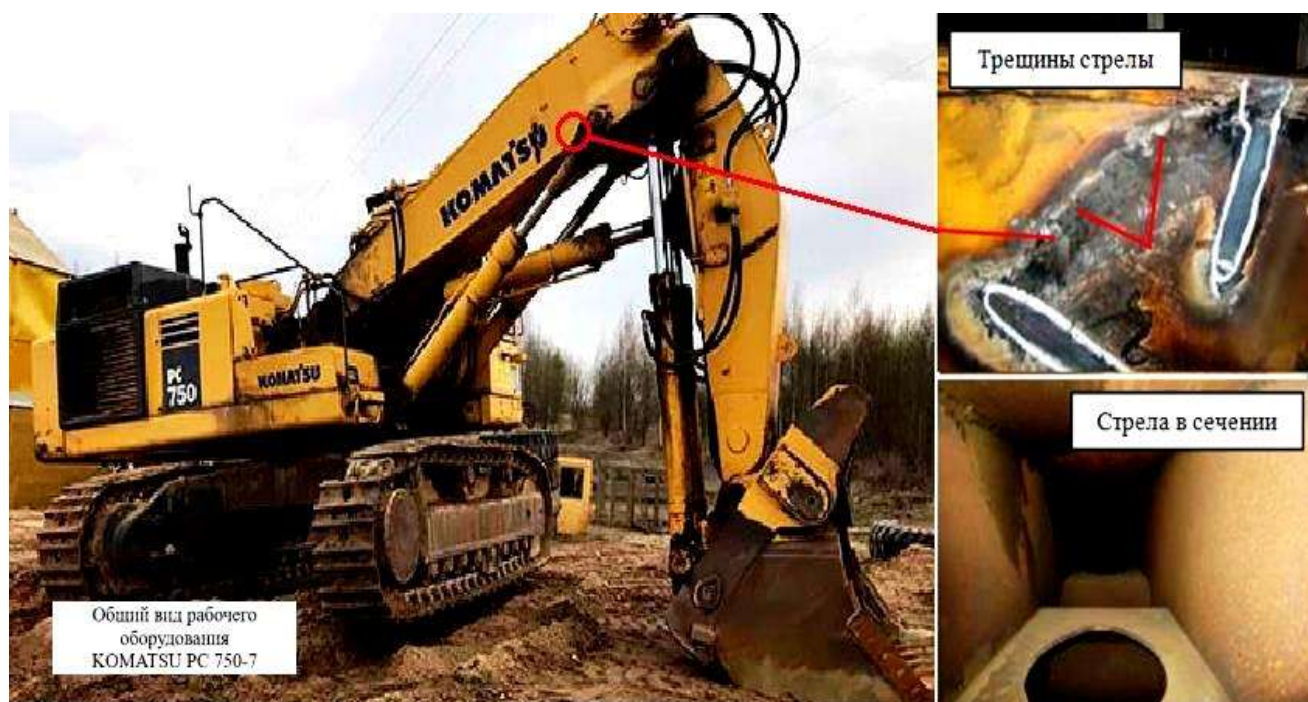
Рисунок 1.7 – Трещина стрелы гидравлического экскаватора Komatsu PC 750-7
