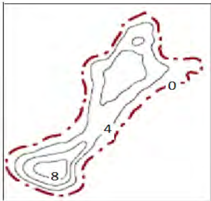
Рис. .1. Пример карты эффективной нефтенасыщенной толщины в м. для нефтяной залежи, используемой для подсчета запасов углеводородов [9]
