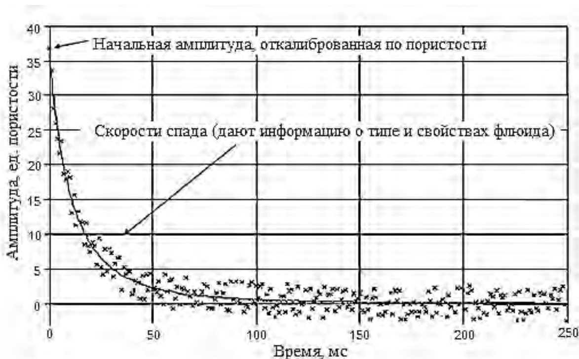
Рис. 7.5. Аппаратурная релаксационная кривая. Отдельные точки - полевые данные, сплошная кривая - их осреднение. Эхо-сигналы записаны со временем между сигналами 1 мсек.
