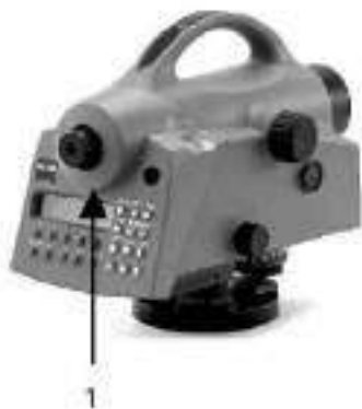
Рис. 4.7 - Юстировка положения сетки нитей
