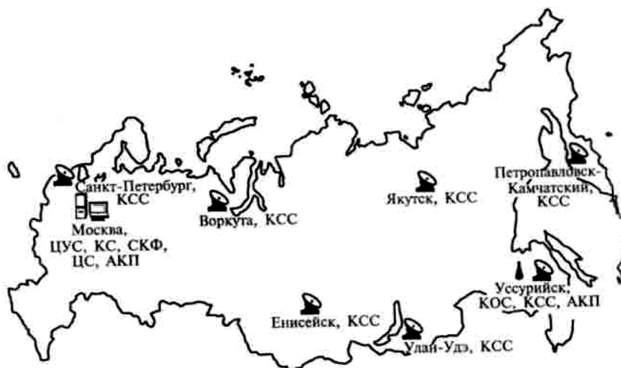
Рис. 4.20. Размещение станций контроля и управления системы ГЛОНАСС: ЦУС – центр управления системой ГЛОНАСС; ЦС – центральный синхронизатор; КС – контрольная станция; СКФ – система контроля фаз; КОС – квантово-оптическая станция; АКП – аппаратура контроля параметров; КСС – контрольная станция слежения
