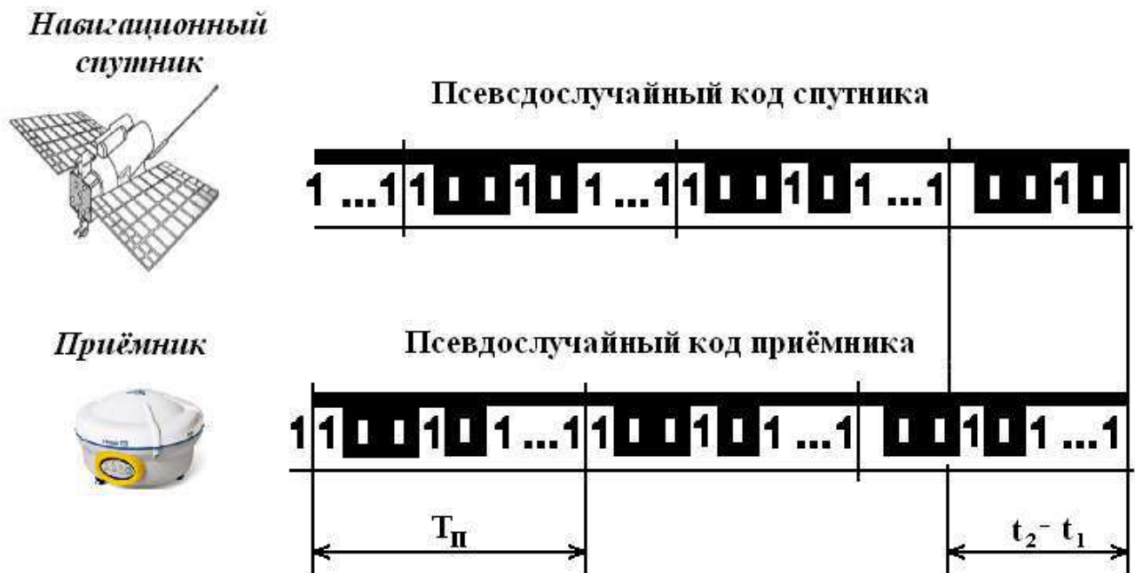
Рис. 4.21. Определение расстояния от GPS спутника до приемника
