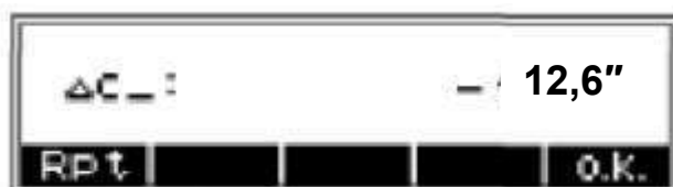
Рис. 12.11. Вывод значения угла i
