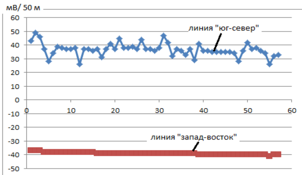
Рис. 3.5. Относительно устойчивые значения разности потенциалов блуждающих токов, измеренные угловой установкой приемных линий длиной 50 м через 10 с в г. Кировграде на перекрёстке ул. Ленина-Кировградская
