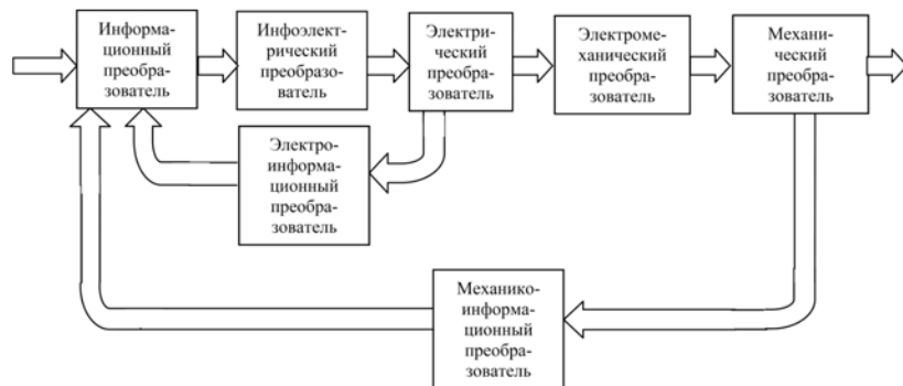
Рис. 8.3. Функциональная модель мехатронного модуля
