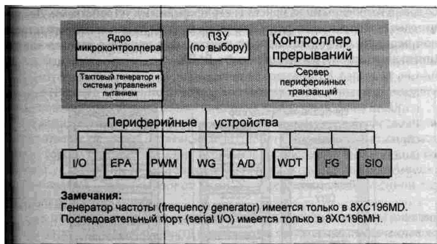
Рис. 18. Типовая архитектура микроконтроллеров семейства MCS-196 на примере микроконтроллеров для управления двигателями 8xC196MC/MD/MH.
