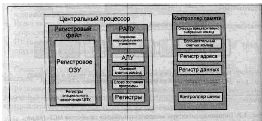
РИС. 19. СТРУКТУРА МОДУЛЯ ЦЕНТРАЛЬНОГО ПРОЦЕССОРА
