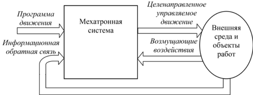
Рис. 8.2. Мехатронный модуль в виде «черного ящика»
