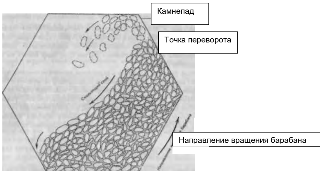
Рис.7. Поведение абразива в галтовочном барабане
