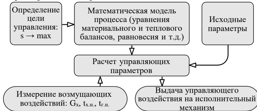
Рис. 2.3. Структура системы управления абсорбционной установкой
