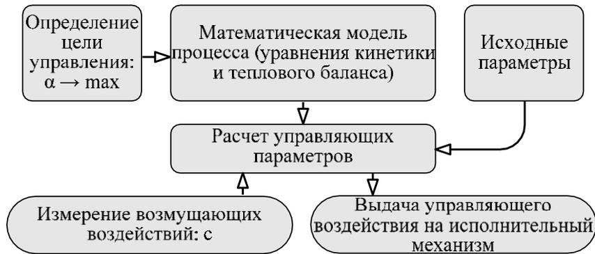
Рис. 4.5. Структура системы управления реакционной установкой
