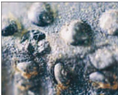
Рис. 2.139. Скол резцов (BT)
