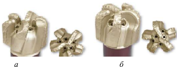
Рис. 1.27. Долота PDC («Волгабурмаш») марки FD – конструктивные особенности – спиральная форма лопастей и установка зубков PDC на калибрующей части долота: а – долота диаметром 214,3 мм – оснащены резцами обратной проработки; б – долото диаметром 215,9 мм – оснащены антивибрационной защитой долота
