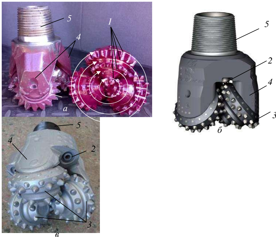
Рис. 1.57. Трехшарошечные долота: а – для бурения мягких горных пород с фрезерованными на шарошках зубьями; б, в – для бурения средних по твердости и твердых горных пород с твердосплавными по- родоразрушающими вставками; 1 – траектории движения венцов шарошек долота; 2 – сопло для выхода промывочной жидкости с боковым расположением; 3 – шарошки; 4 – лапы долота; 5 – резьба.
