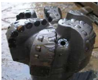
Рис. 1.9. Долото PDC Tornado после проходки 1150 м.
