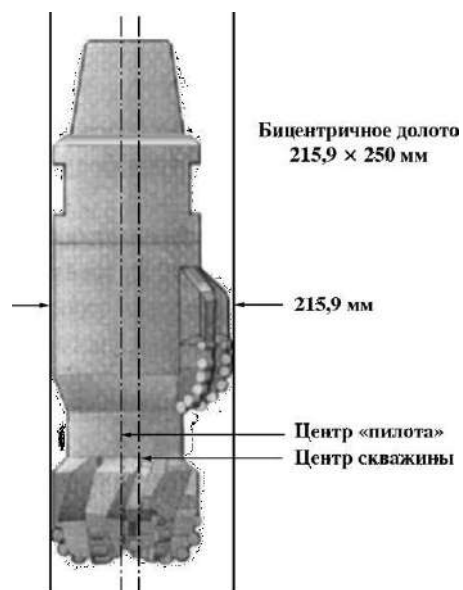
Рис. 2.132. Схема спуска бицентричного долота в скважину
