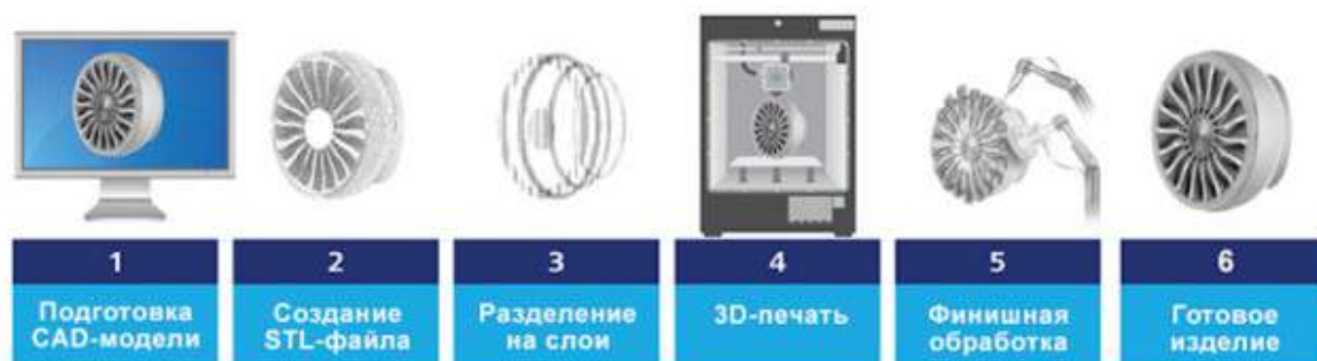
Рисунок 1 - Схема последовательности 3D-печати
