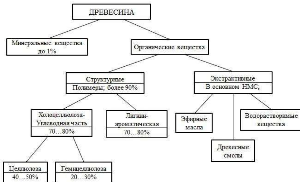
Рис. 46. Схема химического состава древесины.
