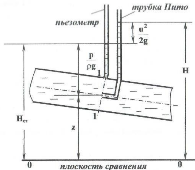
Рис.1.1. Экспериментальное определение статического, полного и скоростного напоров
