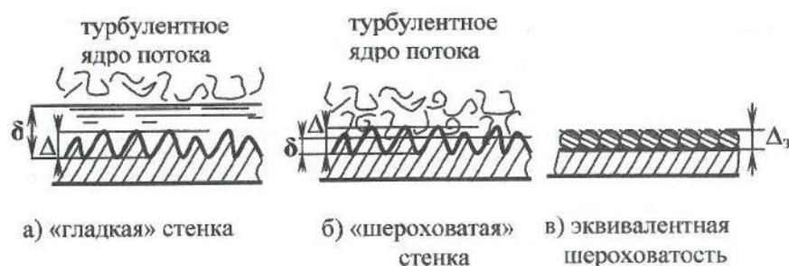
Рис.3.1. К определению понятий гидравлических «гладких» и «шероховатых» труб
