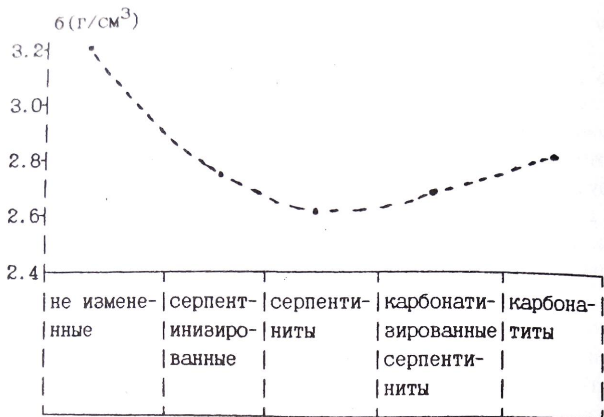
Рис 3.2. Изменение плотности ультраосновных пород в процессе серпентинизации и карбонатизации
