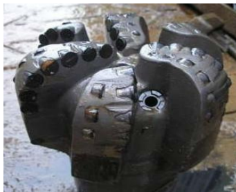
Рис. 1.9. Долото PDC Tornado после проходки 1150 м.
