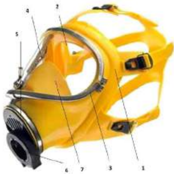
Рис.11. Маска дыхательная «Панорама-Нова» 1 – корпус; 2 – панорамное стекло; 3 – обойма; 4 – стеклоочиститель; 5 – мембрана разговорная; 6 – разговорно-соединительное устройство; 7 – подмасочник;
