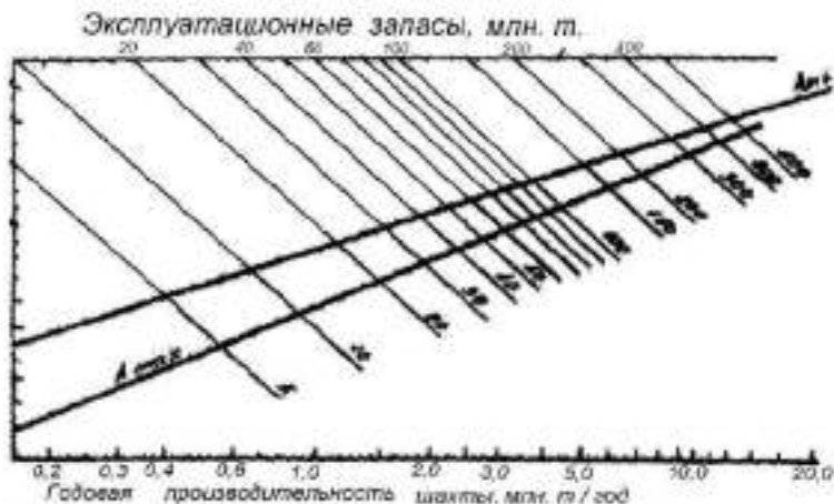
Рис. 3.1. Диаграмма для определения годовой производительности рудника (глубины до 600 м).
