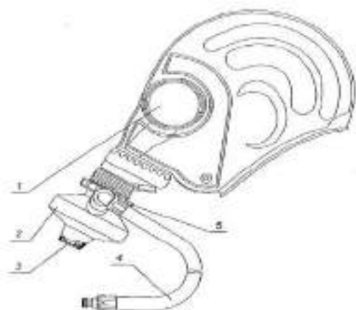
Рис. 20. Спасательное устройство 1-маска спасательного устройства; 2 - легочный автомат; 3 - кнопка байпаса; 4 - шланг; 5 - гайка.
