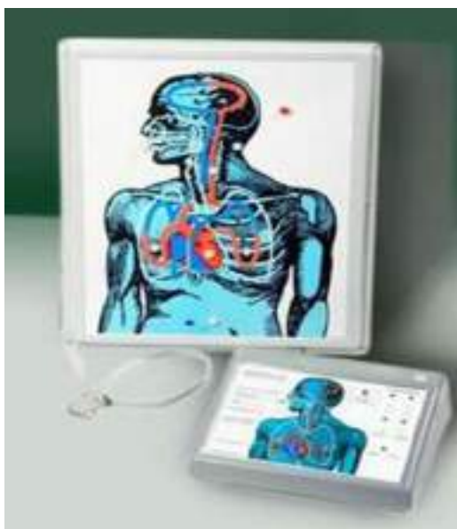
Рис. 2. Общий вид электронного пульта контроля и настенного табло
