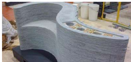
Рис. 4.3. – Изделия, напечатанные бетоном
