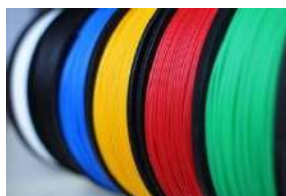
Рис. 4.1. – АВС-пластик для 3D печати на учебно-бытовом принтере
