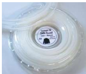
Рис. 4.10. – Нейлоновая нить для 3D печати
