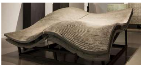
Рис. 4.3. – Изделия, напечатанные бетоном
