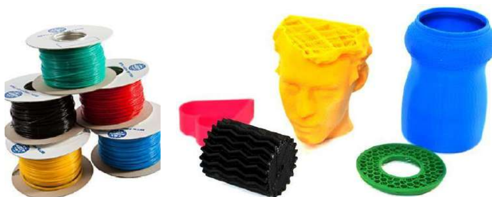
Рис. 4.13. – Полилактидная нить и изделия, напечатанные полилактидом на 3D принтере
