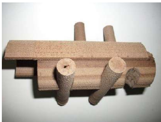
Рис. 4.7. – 3D модель, напечатанная деревянным волокном
