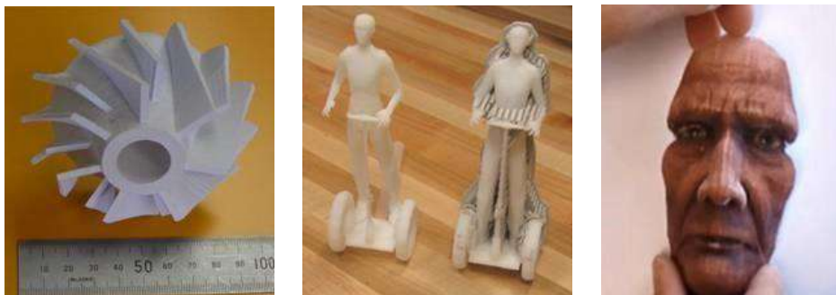
Рис. 4.5. – 3D модели, напечатанные из бумаги
