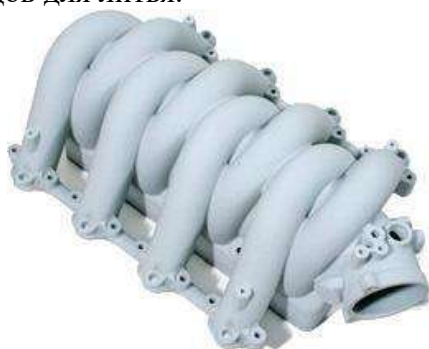
Рис. 4.6. – 3D модель, напечатанная из гипса
