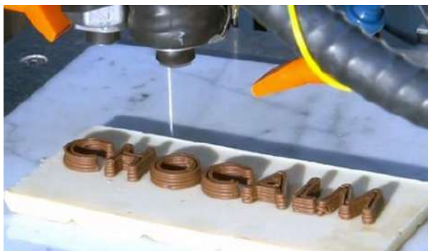
Рис. 4.14. – Шоколадный принтер в работе
