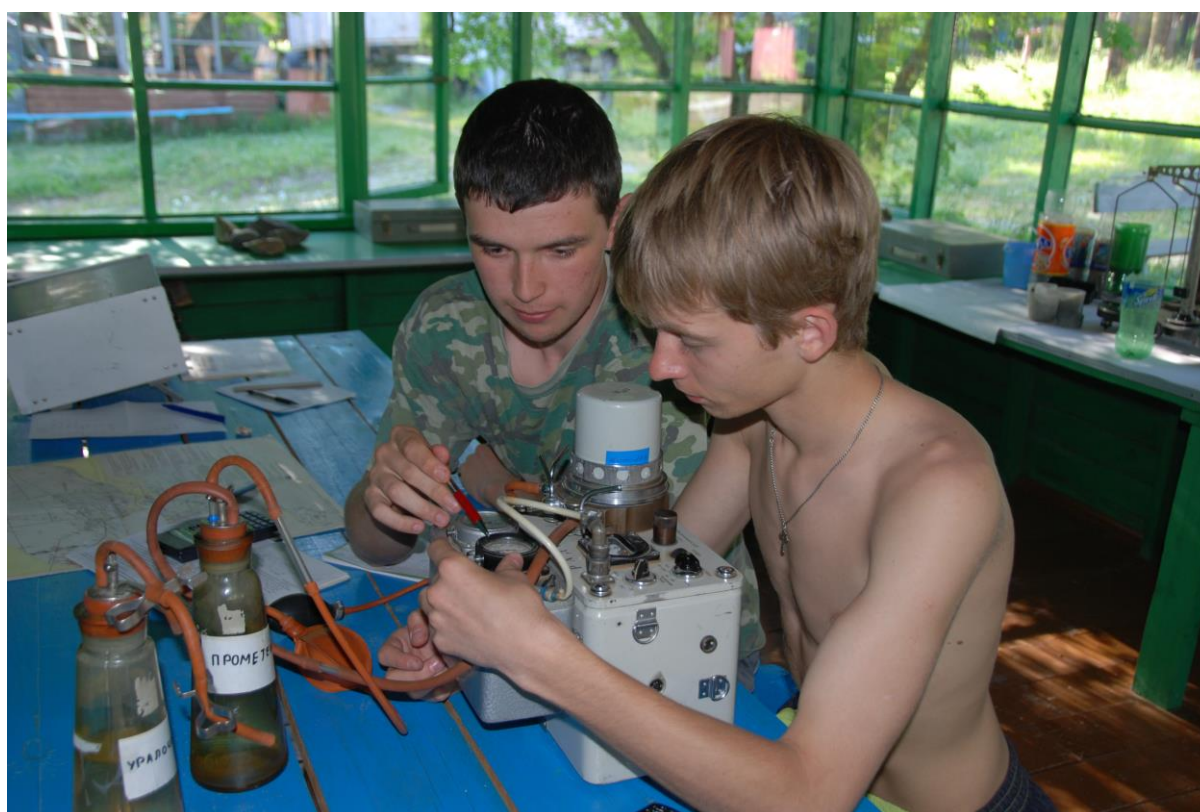
Рис. 4.4. Процесс измерения концентрации радона в водных пробах, отобранных в разных точках Верх-Сысертского участка
