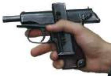
Рис. 11.12. Проверка отсутствия патрона
