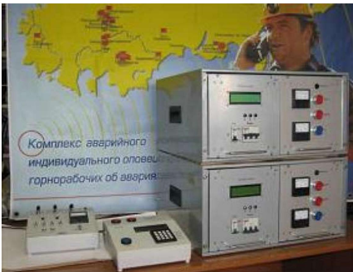
Комплекс аварийного оповещения и селективного вызова СУБР-1П предназначен для выполнения требований § 41 ПБ 05-618-03 в части обеспечения оповещения горнорабочих и ИТР, находящихся в подземных выработках, об авариях и их индивидуального (селективного) вызова, а также передачи информации на индивидуальный текстовый приёмник.
