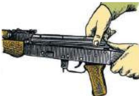
Рис. 12.36. Отделение крышки ствольной коробки
