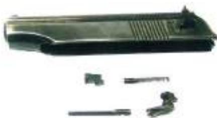
**Рис. 11.3.** Затвор с ударником, выбрасывателем и предохранителем
