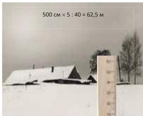
**Рис. 15.5.** Определение расстояний по линейным размерам объектов
