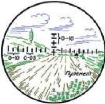
Рис. 15.7. Измерение угла при помощи бинокля
