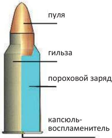
Рис. 14.1. Устройство патрона
