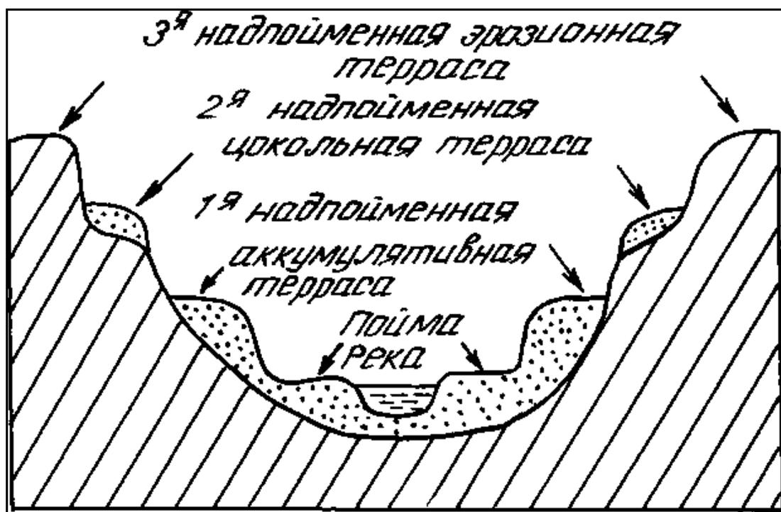
Рис.4. Схематический разрез речных террас
