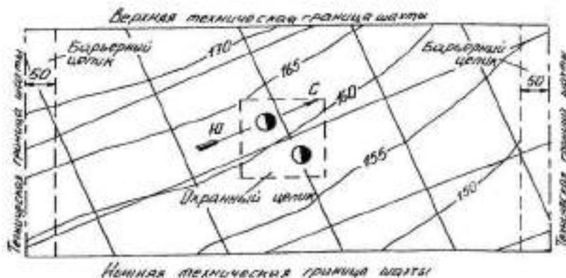
Рис. 3.1. Графическая интерпретация потерь угля в шахтном поле
