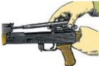
Рис. 12.38. Отделение затворной рамы с затвором
