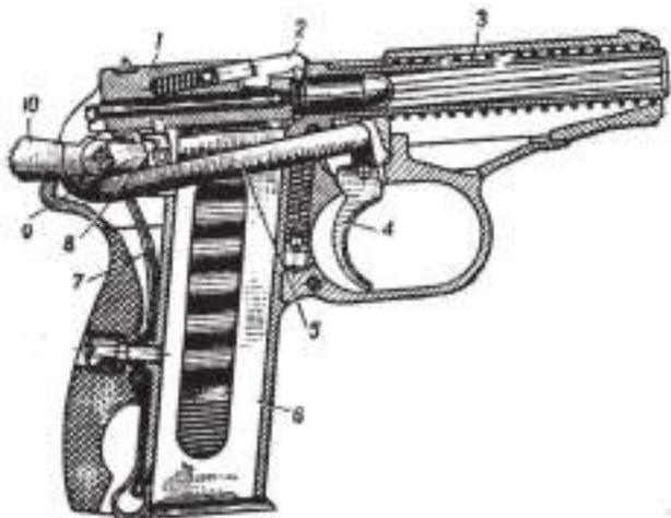
**Рис. 11.10.** Положение частей и механизмов пистолета перед выстрелом: 1 – затвор; 2 – выбрасыватель; 3 – возвратная пружина; 4 – спусковой крючок; 5 – спусковая тяга; 6 – магазин; 7 – боевая пружина; 8 – шептало с пружиной; 9 – рычаг взвода; 10 – курок
