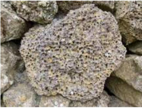
**п о р и с т а я** – определяется наличием округлых или неправильной формы пустот размером 1-10 мм;
