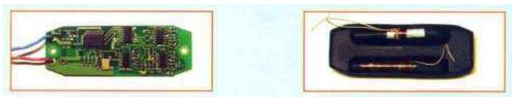
Интегрирующим сигнально-информационным устройством системы «Радиус-2» является шахтерское многофункциональное приемное устройство «Радиус 1-ПРМ 8».
