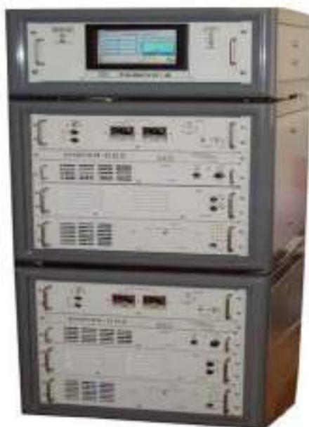
Устройство передающее (ПРД-2) конструктивно состоит из: усилителя мощности (УМ), блока контроля согласования (БКС), пульта дистанционного управления (ПДУ), антенно-фидерного устройства (АФУ).
