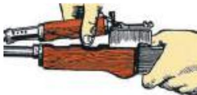
Рис. 12.40. Отделение газовой трубки со ствольной накладкой
