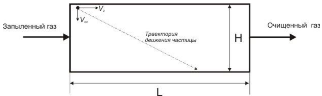
Рисунок 2. К расчету пылеосадительной камеры.
