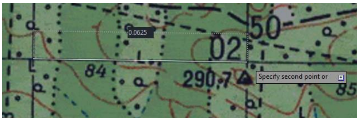
Рисунок 6 – Измерение расстояния между крестами километровой сетки.
