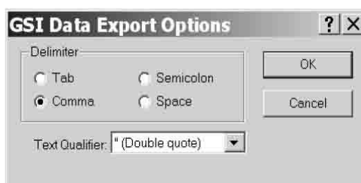
Рис. I.9. Окно параметров экспорта данных при сохранении их в формате «Golden Software Data (*.DAT)»
