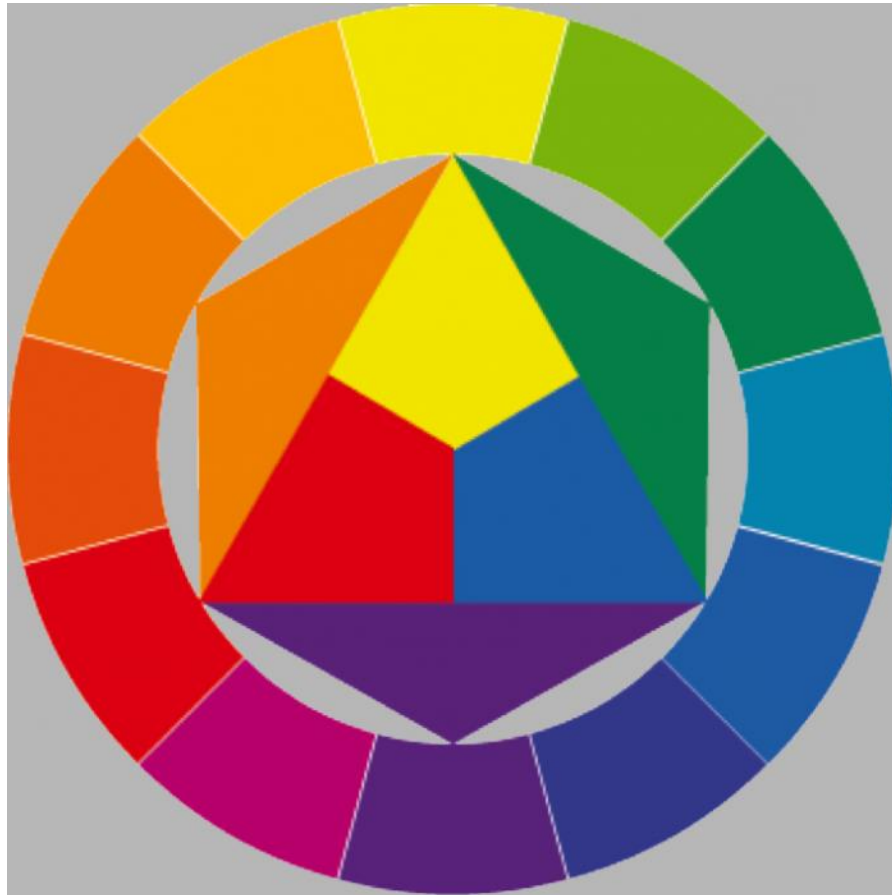
Рис. П. 39 12-секторный цветовой круг И. Иттона с включенными в него треугольником, представляющим три основных независимых цвета, и шестигранником, представляющим смеси этих цветов
