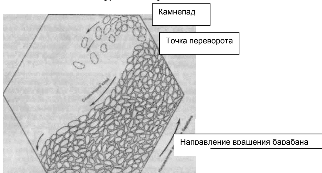
Рис.7. Поведение абразива в галтовочном барабане
