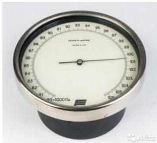
Рис. 3.1 Барометр-анероид «БААМ-1»
