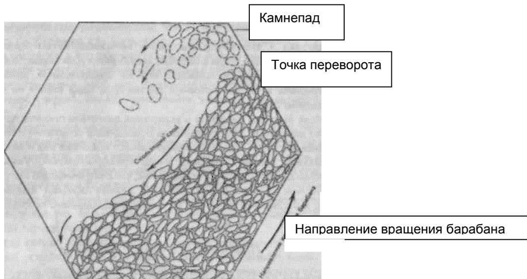
Рис.7. Поведение абразива в галтовочном барабане
