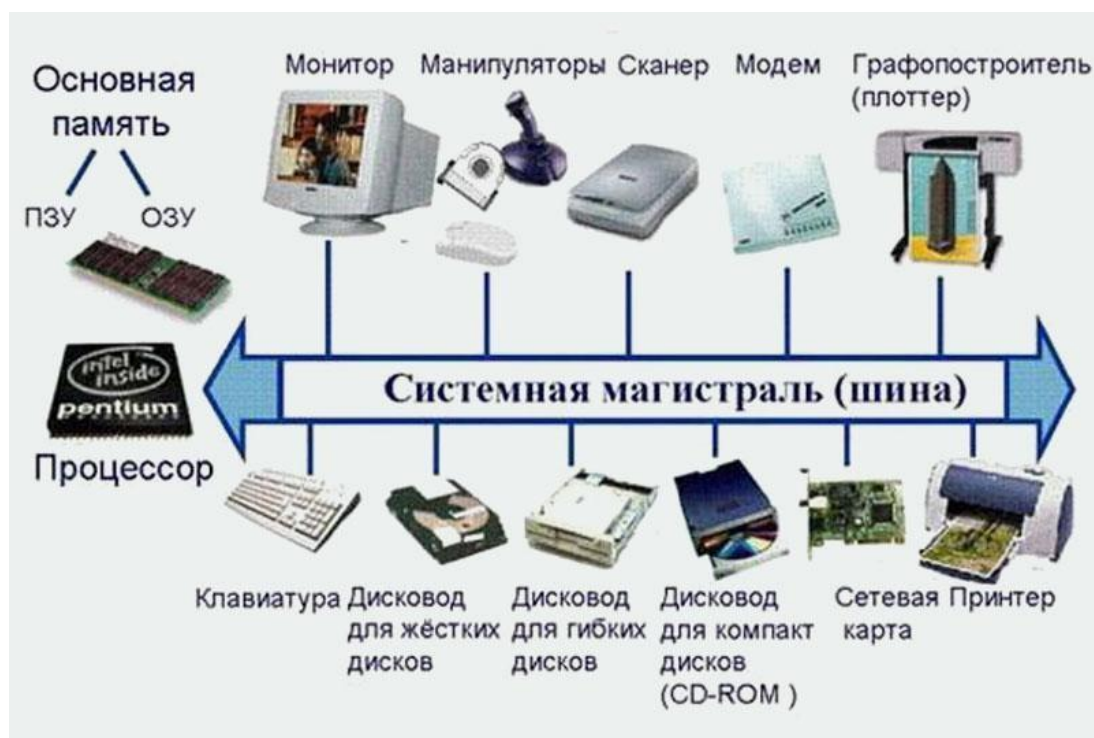
Рис. 1.12. Принцип обмена информацией между устройствами ПК
