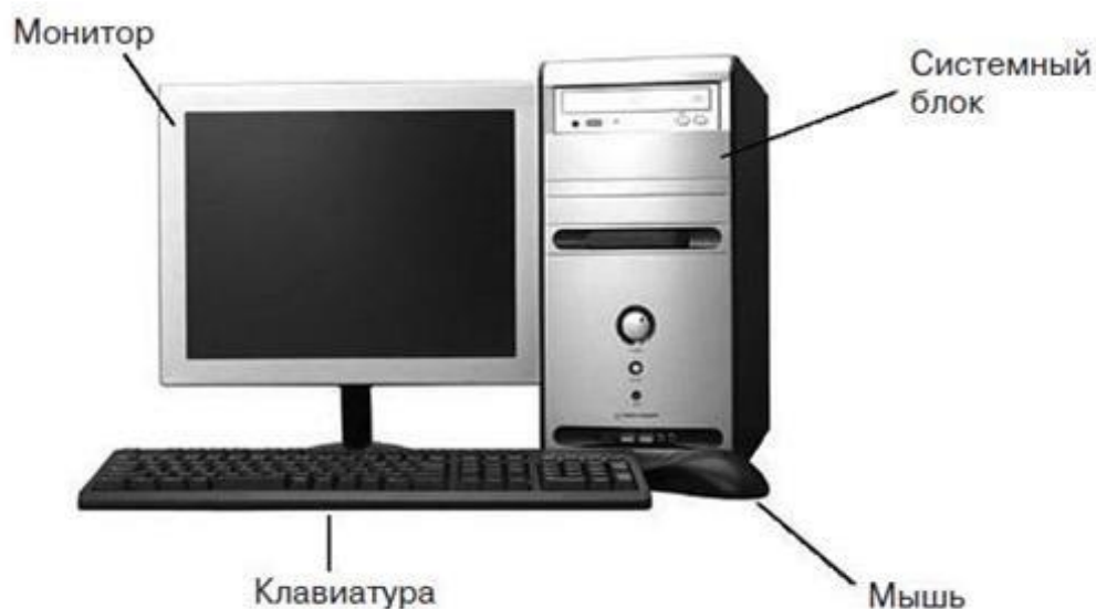
Рис. 1.7. Базовая конфигурация ПК
