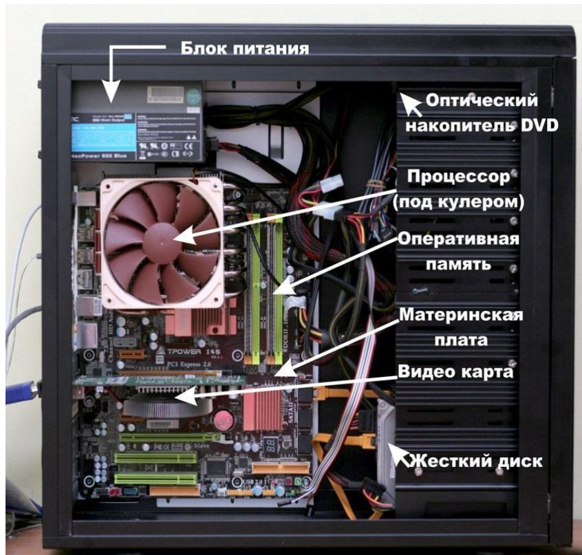
Рис. 1.8. Внутренние устройства системного блока
