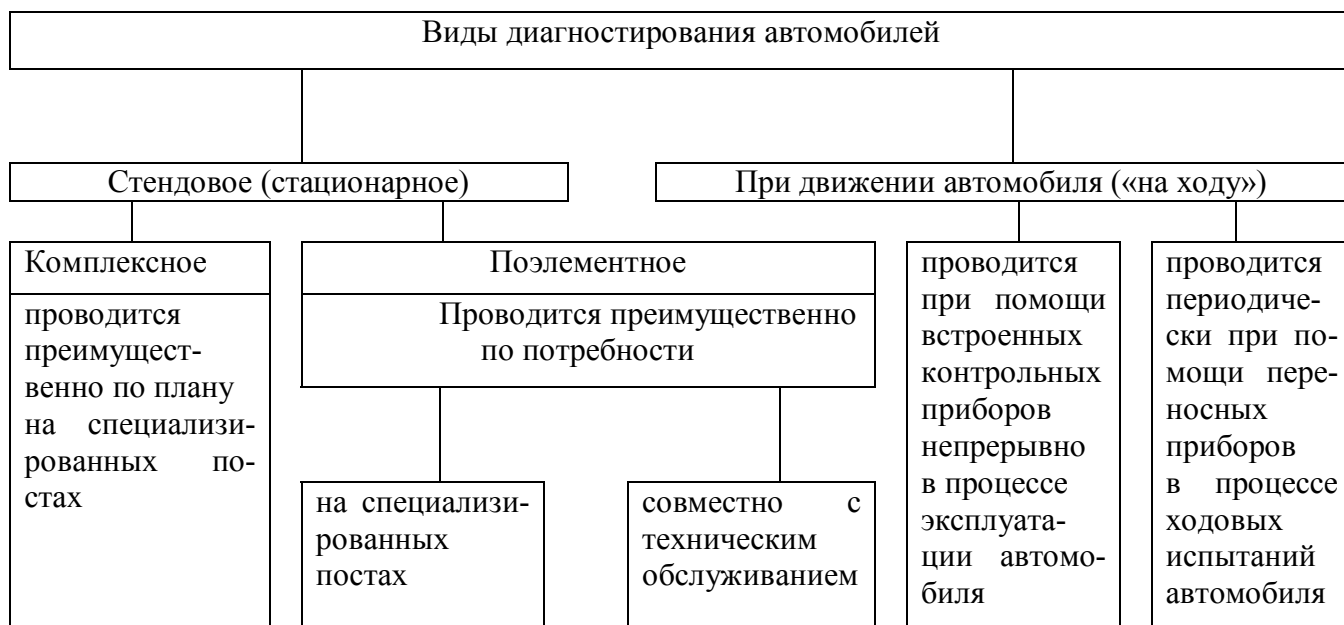
Рис. 2. Виды диагностирования по их технологической принадлежности
