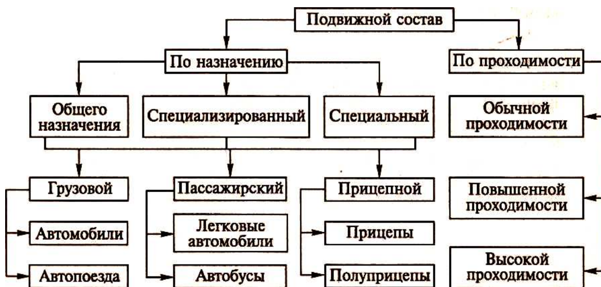
Рис. 8. Типы подвижного состава автомобильного транспорта
