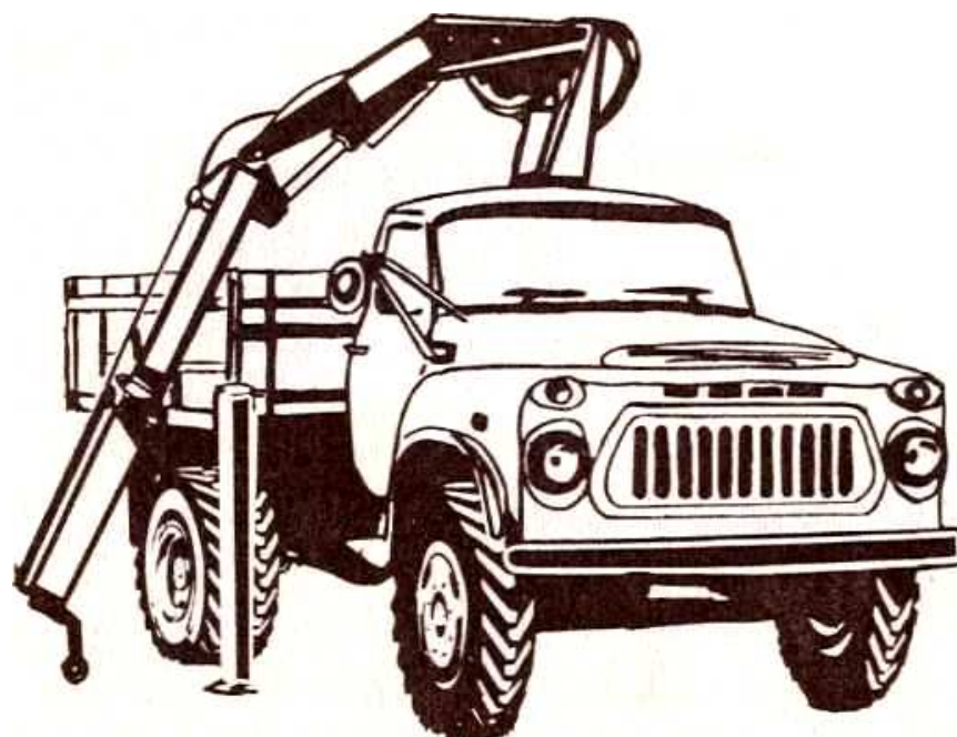
Рис. 20. Автомобиль-самопогрузчик со стреловым краном
