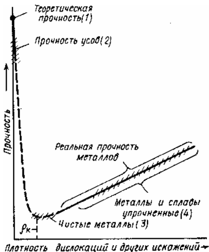
Рис. 31. Зависимость прочности материала от плотности дислокаций в нем
