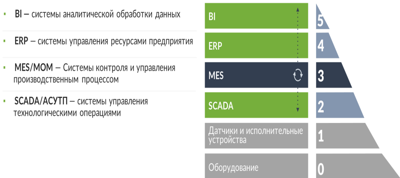
Рис.5. Уровни автоматизация АСУ ТП и АСУ П
