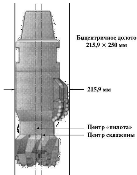
Рис. 2.132. Схема спуска бицентричного долота в скважину
