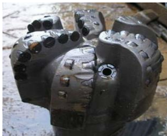
Рис. 1.9. Долото PDC Tornado после проходки 1150 м.
