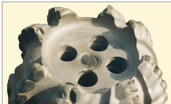
Рис. 2.144. Общий вид долота после четвертого спуска. Спецификация долота: тип R435SG; размер 12,25"; общая площадь потока 0,65– 1,60.
