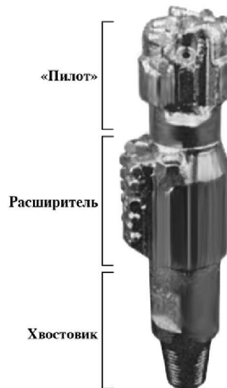
Рис. 2.130. Элементы бицентричного долота
