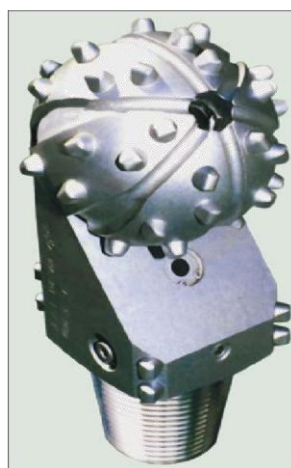
Рис.2.111. Общий вид одношарошечного долота с открытой опорой
