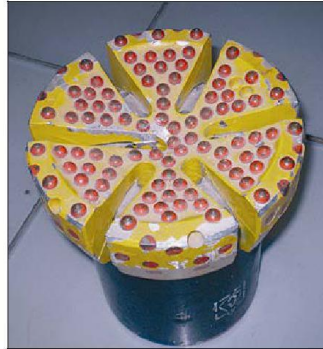
Рис.2.121. Общий вид долота ИСМ торцового типа.
