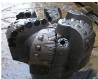
Рис. 1.9. Долото PDC Tornado после проходки 1150 м.
