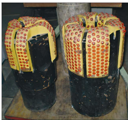
Рис.2.149. Общий вид бурильных головок ИСМ
