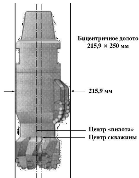
Рис. 2.132. Схема спуска бицентричного долота в скважину
