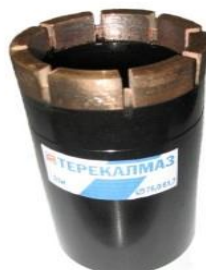
Рис. 2.44. Импригнированная буровая коронка 33И.
