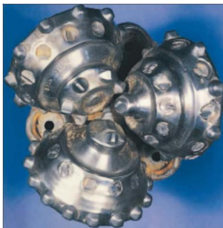
Рис.2.115. Общий вид отработанного долота, описанного в примере
