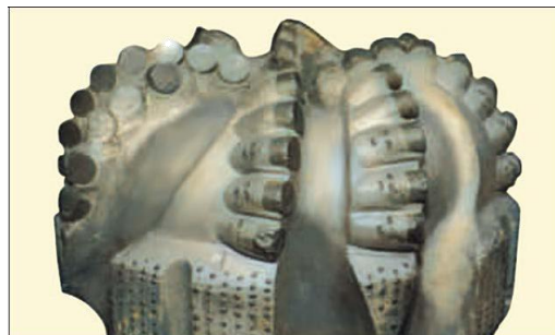
Рис.2.142. Общий вид долота после подъема. Спецификация долота: тип R437GN; размер 8,5"; общая площадь потока 0,6
