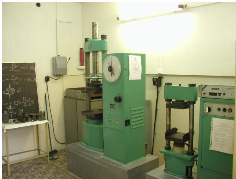
Рис. 1 Прессы в лаборатории физико-механических свойств горных пород
