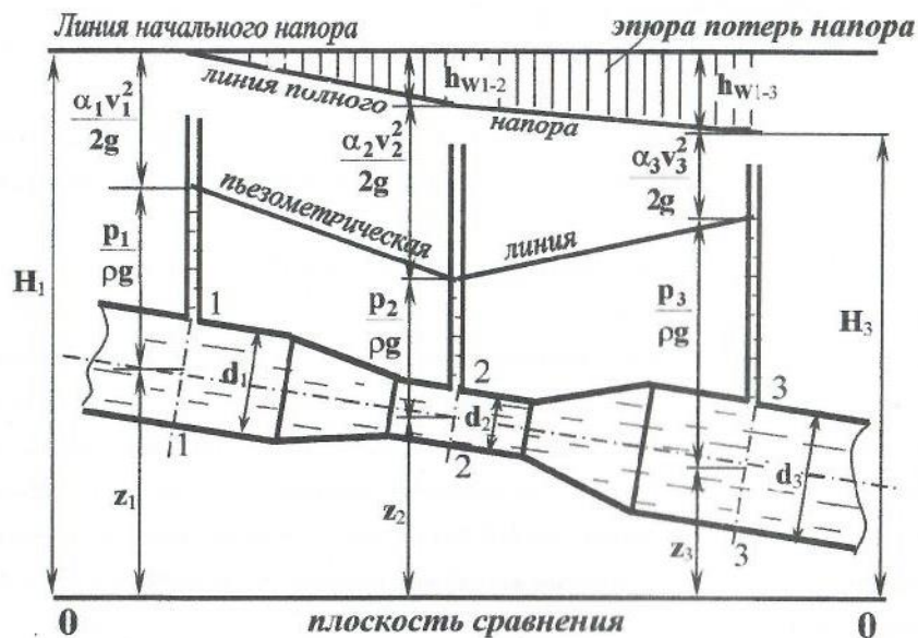
Рис.1.2. Диаграмма уравнения Бернулли для потока вязкой жидкости
